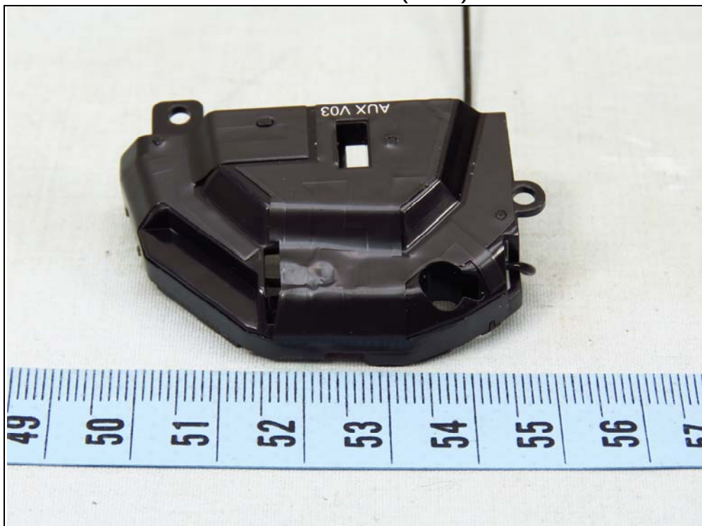
LTE antenna (Aux.)
