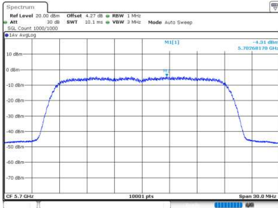
PSD NVNT ax20 5700MHz Ant1
