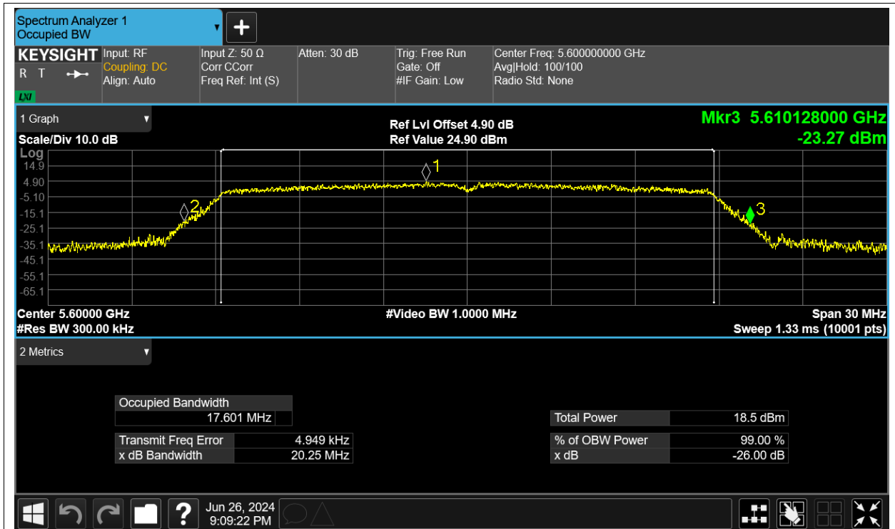
-26dB Bandwidth NVNT n20 5700MHz Ant1
