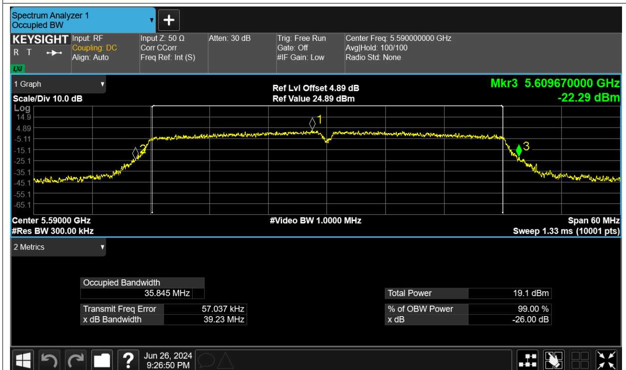
-26dB Bandwidth NVNT n40 5670MHz Ant1
