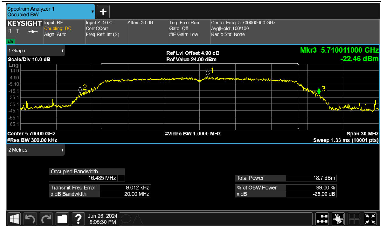
-26dB Bandwidth NVNT ac20 5500MHz Ant1
