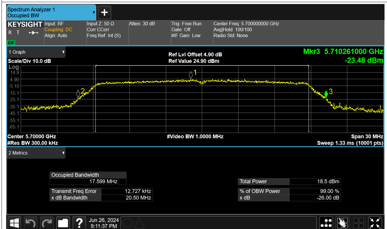
-26dB Bandwidth NVNT n40 5510MHz Ant1
