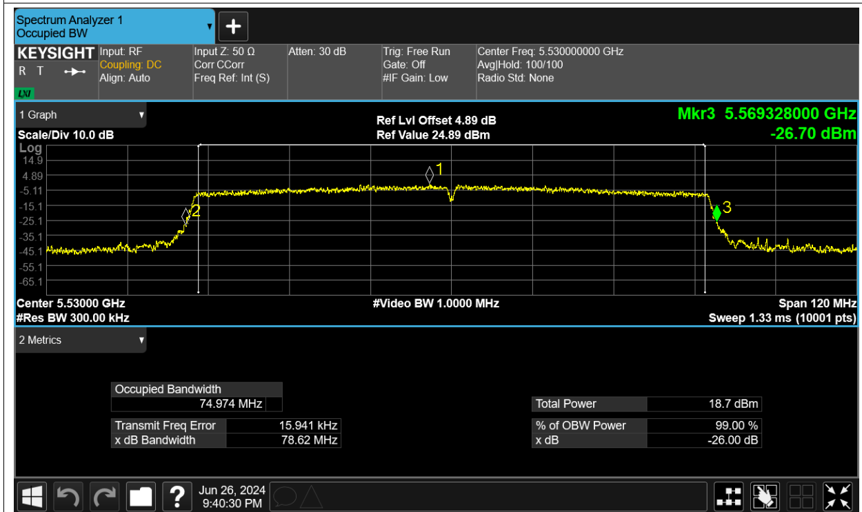
-26dB Bandwidth NVNT ac80 5610MHz Ant1
