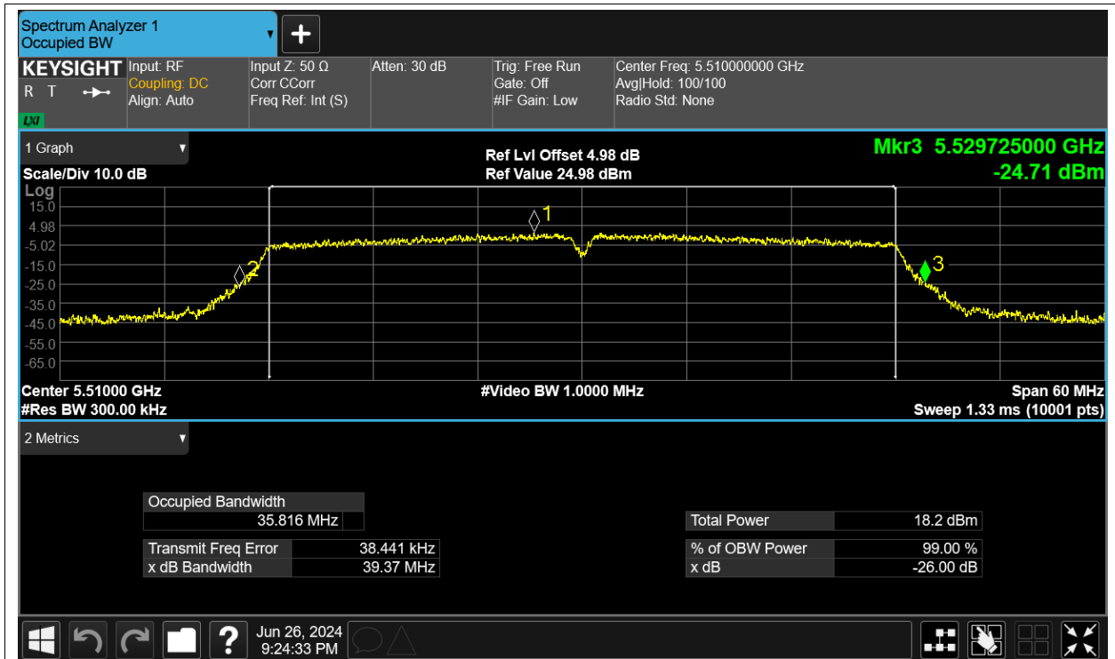
-26dB Bandwidth NVNT n40 5590MHz Ant1
