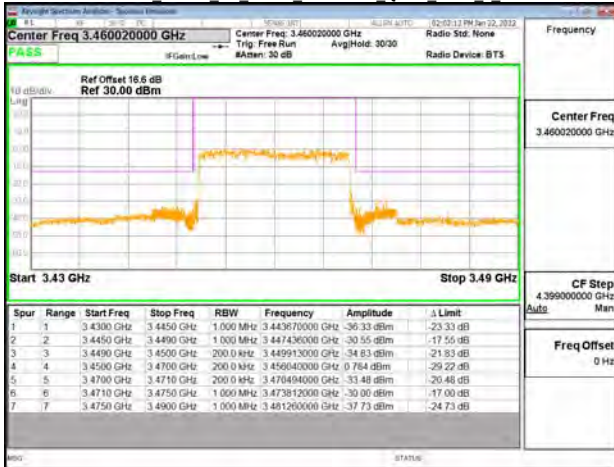
Band77-Part27 20MHz CP OFDM SCS30kHz QPSK RB51 0 CH633334
