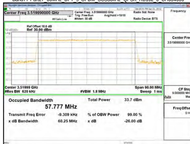
Band77-Part27 60MHz DFT s OFDM SCS30kHz QPSK RB162 0 CH634666
