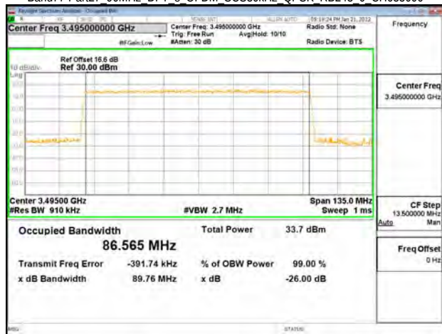
Band77-Part27 90MHz DFT s OFDM SCS30kHz QPSK RB243 0 CH633334
