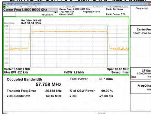
Band77-Part27 60MHz DFT s OFDM SCS30kHz QPSK RB162 0 CH634666
