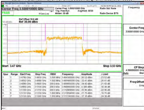
Band77-Part27 20MHz CP OFDM SCS30kHz QPSK RB51 0 CH636000
