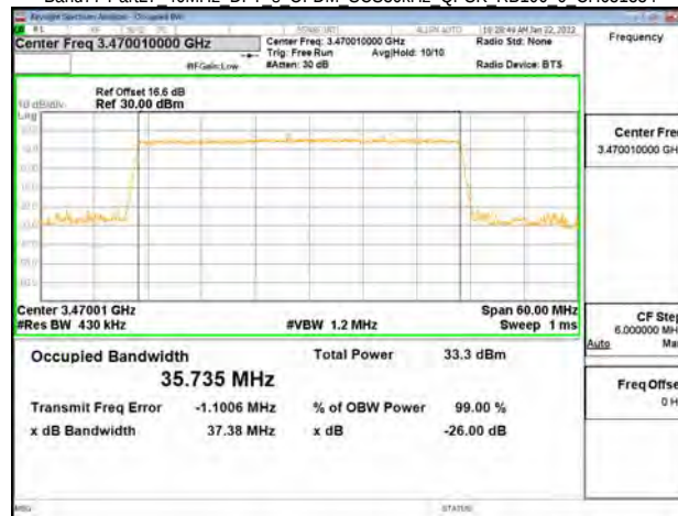
Band77-Part27 40MHz DFT s OFDM SCS30kHz QPSK RB100 0 CH633334
