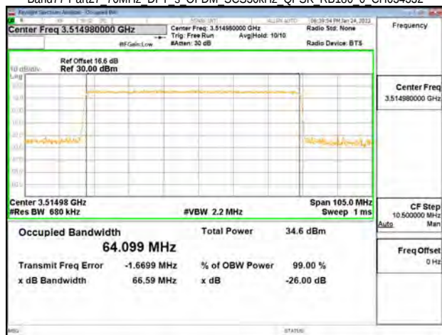
Band77-Part27 70MHz DFT s OFDM SCS30kHz QPSK RB180 0 CH634332
