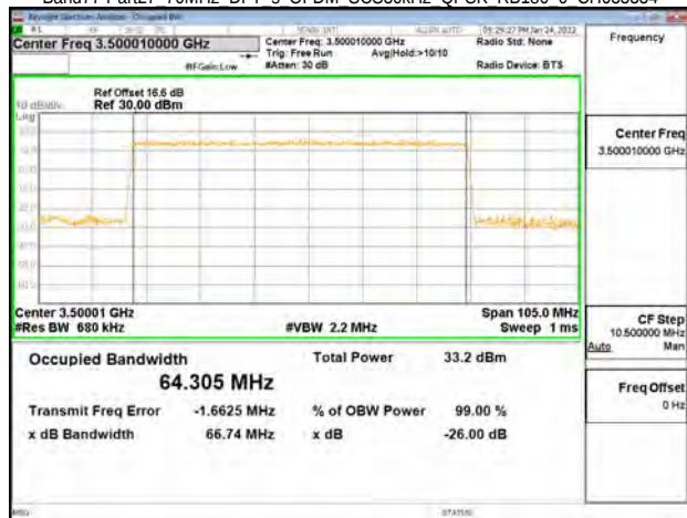
Band77-Part27 70MHz DFT s OFDM SCS30kHz QPSK RB180 0 CH634332
