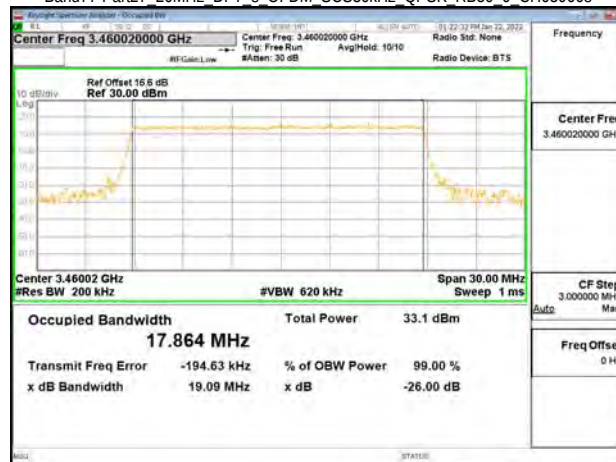
Band77-Part27 20MHz DFT s OFDM SCS30kHz QPSK RB50 0 CH633334
