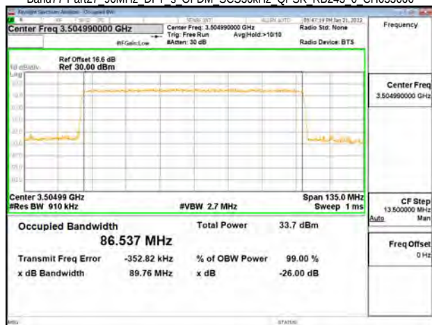
Band77-Part27 90MHz DFT s OFDM SCS30kHz QPSK RB243 0 CH633666
