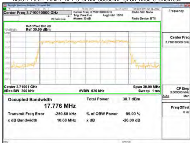
Band77-Part27 20MHz DFT s OFDM SCS30kHz QPSK RB50 0 CH647334
