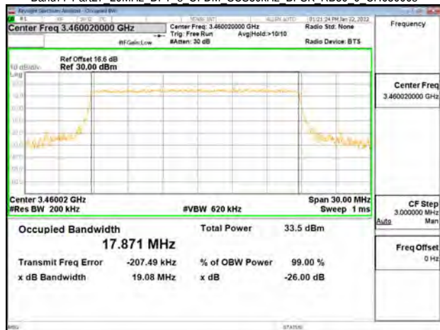
Band77-Part27 20MHz DFT s OFDM SCS30kHz BPSK RB50 0 CH633334
