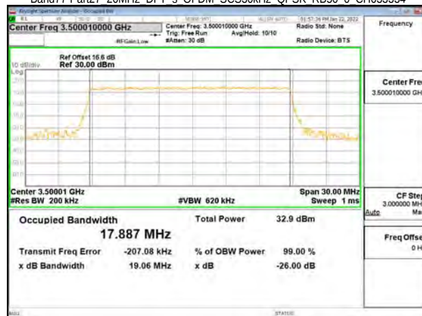
Band77-Part27 20MHz DFT s OFDM SCS30kHz QPSK RB50 0 CH636000
