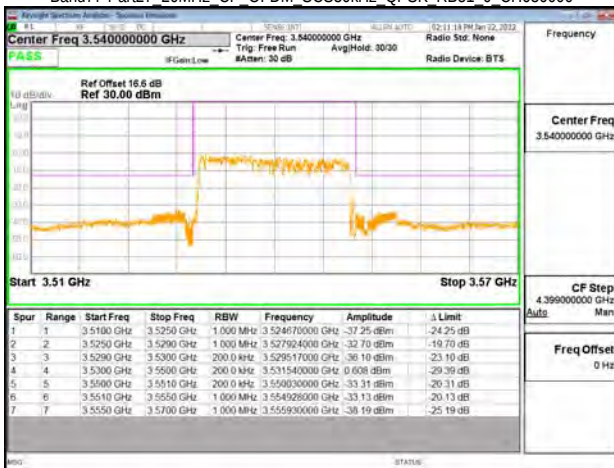
Band77-Part27 20MHz CP OFDM SCS30kHz QPSK RB51 0 CH636000
