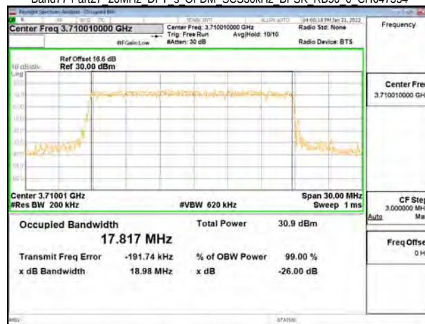
Band77-Part27 20MHz DFT s OFDM SCS30kHz BPSK RB50 0 CH647334
