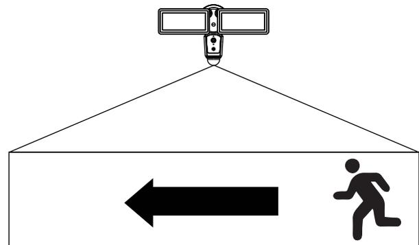
Le détecteur perçoit les mouvements dans la zone de détection.
