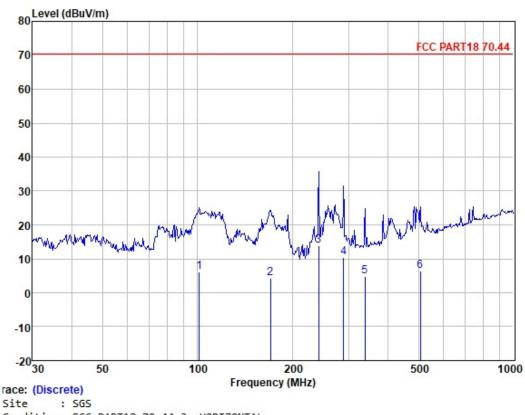
Site : SGS Condition: FCC PART18 70.44 3m HORIZONTAL Job : Model : Power :
