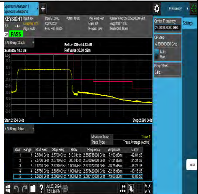
Band7 15MHz QPSK 21375 75RB#0
