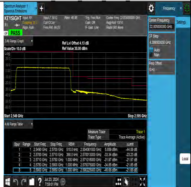
Band7 20MHz QPSK 21350 100RB#0
