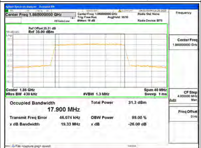
Band2 / 20MHz / QPSK/ Low CH
