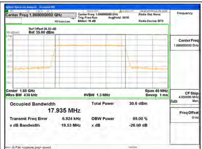
Band2 / 20MHz / 16QAM/ Mid CH
