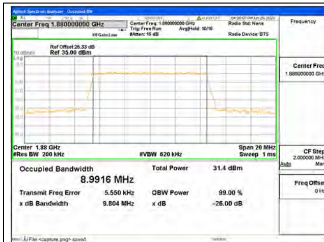
Band2 / 10MHz / QPSK/ Mid CH
