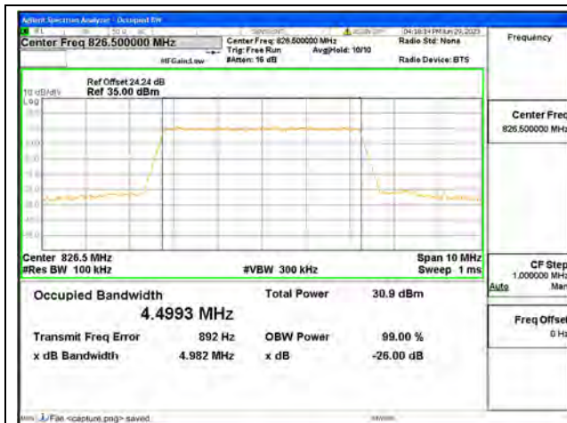
Band5 / 5MHz / QPSK/ Low CH
