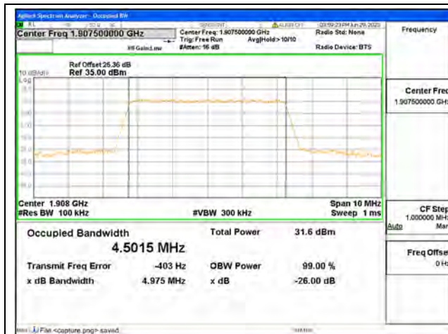
Band2 / 5MHz / QPSK/ High CH
