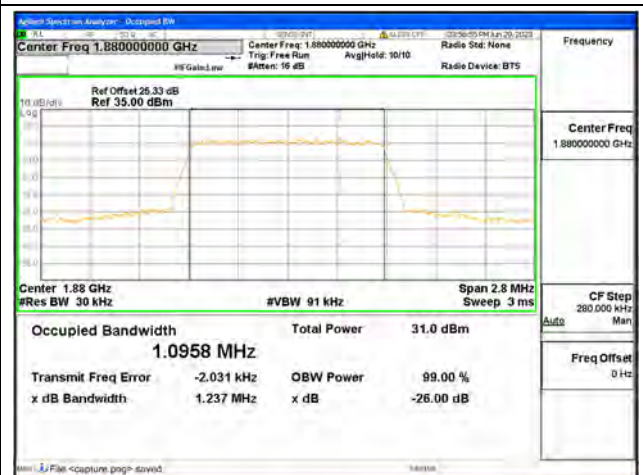
Band2 / 1.4MHz / QPSK/ Mid CH
