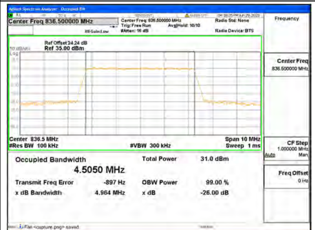
Band5 / 5MHz / QPSK/ Mid CH
