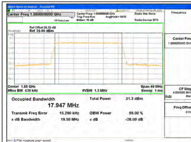
Band2 / 20MHz / QPSK/ Mid CH
