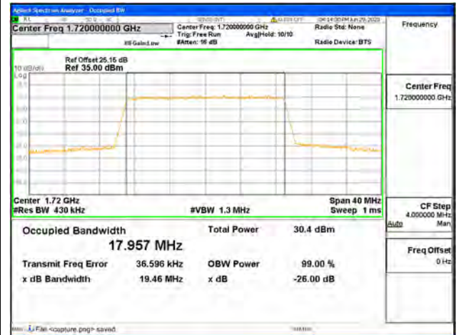
Band4 / 20MHz / QPSK/ Low CH
