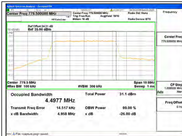
Band13 / 5MHz / QPSK/ Low CH
