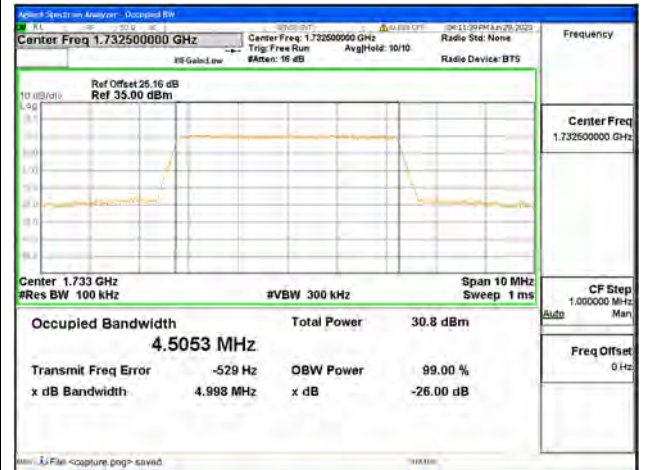
Band4 / 5MHz / QPSK/ Mid CH
