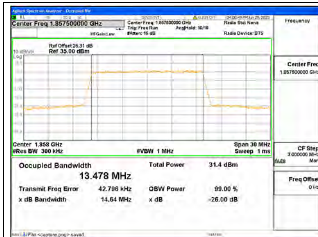
Band2 / 15MHz / QPSK/ Low CH
