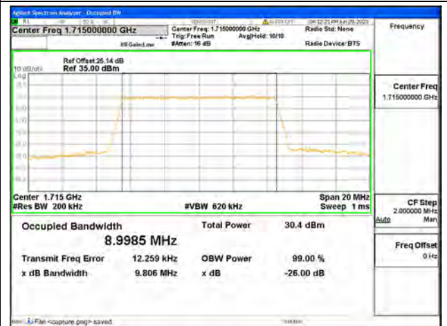
Band4 / 10MHz / QPSK/ Low CH
