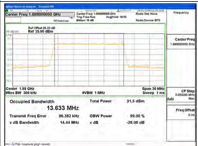
Band2 / 15MHz / QPSK/ Mid CH
