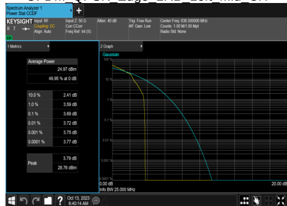
N5(20M)_DFT-s-OFDM QPSK Edge 1RB Left Mid CH
