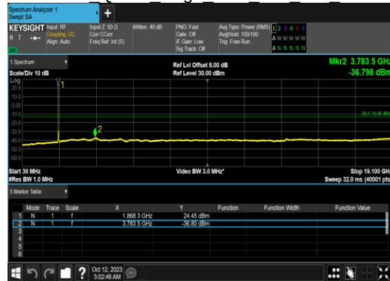
N2(25M)_DFT-s- OFDM QPSK Edge 1RB Left Mid CH
