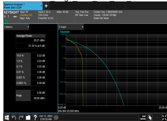
N2(20M)_DFT-s-OFDM_PI_2-BPSK Edge 1RB Left Mid CH
