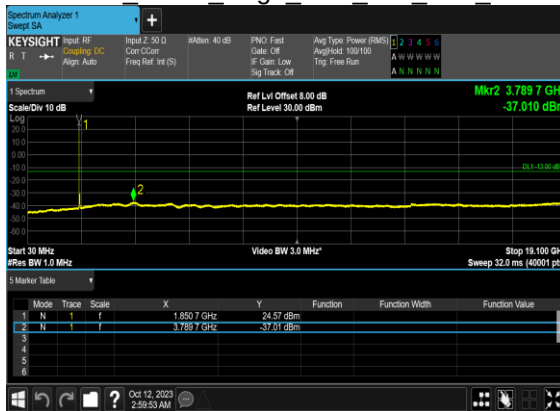
N2(25M)_DFT-s- OFDM BPSK Edge 1RB Left Low CH
