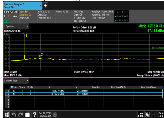
N2(25M)_DFT-s- OFDM QPSK Edge 1RB Left Low CH
