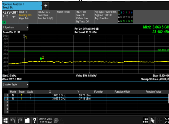
N2(25M)_DFT-s- OFDM BPSK Edge 1RB Left Mid CH
