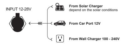
RECOMMEND TO DISCONNECT THE POWER STATION WHEN IT FULLY CHARGED.
