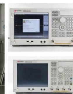
拥有AGILENT5071系列网络分析仪、AGILENT8960、RS CM W500、4438C等终端测试设备,提供天线性能测试。
