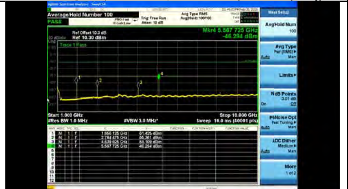
Mod: OQPSK, Mode 192, 927.8MHz (1-10GHz) Avg
