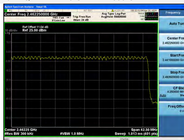
\pi/4 -DQPSK 2.4415 GHz ~ 2.4835 GHz
