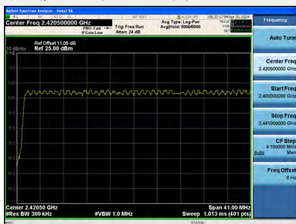
\pi/4 -DQPSK 2.4 GHz ~ 2.4415 GHz
