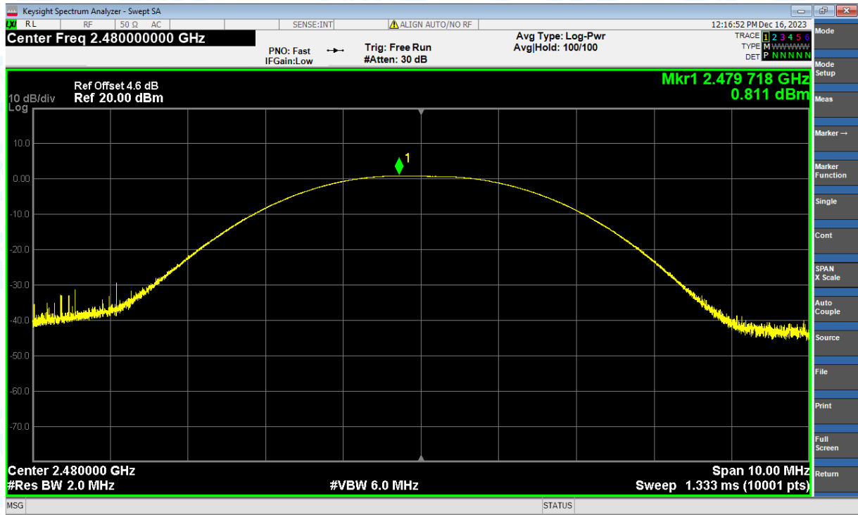
Power NVNT BLE 2Mbps 2402MHz Ant1
