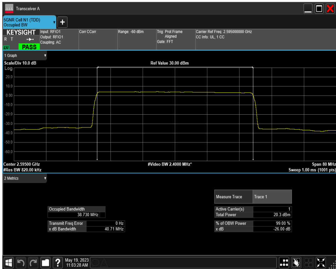
n38 SCS=15kHz DFT_QAM256 BW=40MHz Channel=519000 RB=216@0
