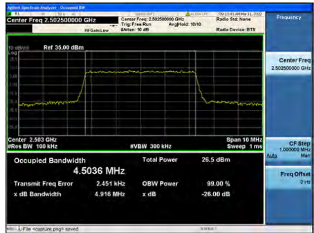
Band7 / 5MHz / Mid CH / QPSK
