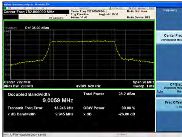
Band13 / 10MHz / Mid CH / 64QAM
