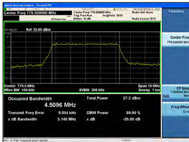
Band13 / 5MHz / Mid CH / 16QAM
