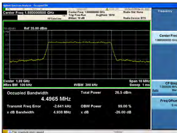
Band2 / 5MHz / Mid CH / 16QAM
