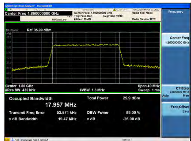
Band2 / 20MHz / Low CH / 64QAM
