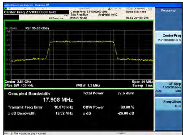
Band7 / 20MHz / Low CH / 64QAM
