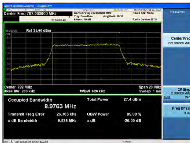
Band13 / 10MHz / Low CH / 16QAM
