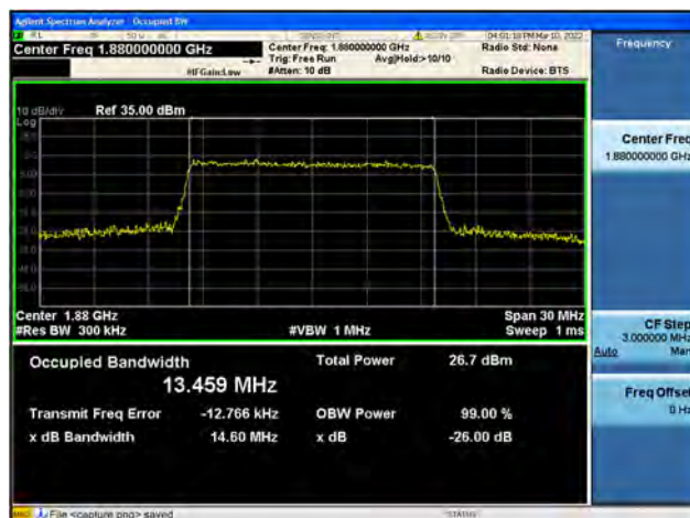
Band2 / 15MHz / Mid CH / 16QAM
