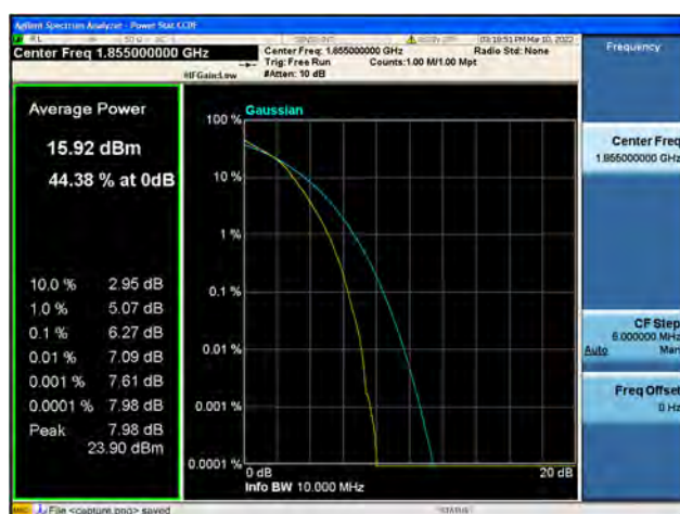
Band2 / 10MHz / Low CH / 16QAM
