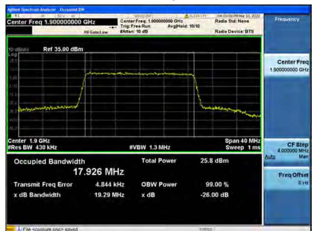
Band2 / 20MHz / High CH / 64QAM
