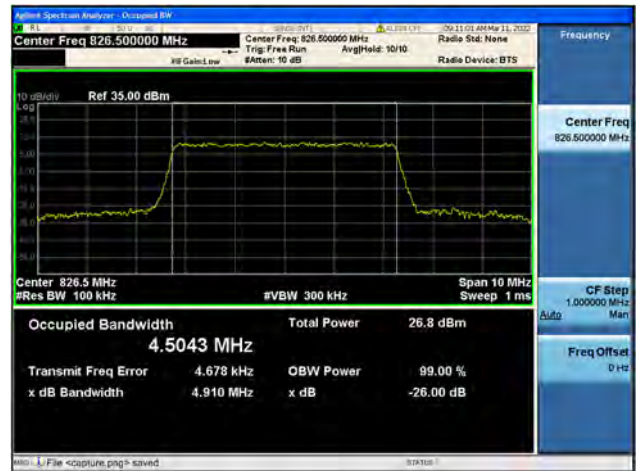
Band5 / 5MHz / Mid CH / QPSK
