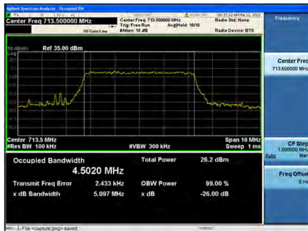
Band17 / 10MHz / Low CH / 16QAM
