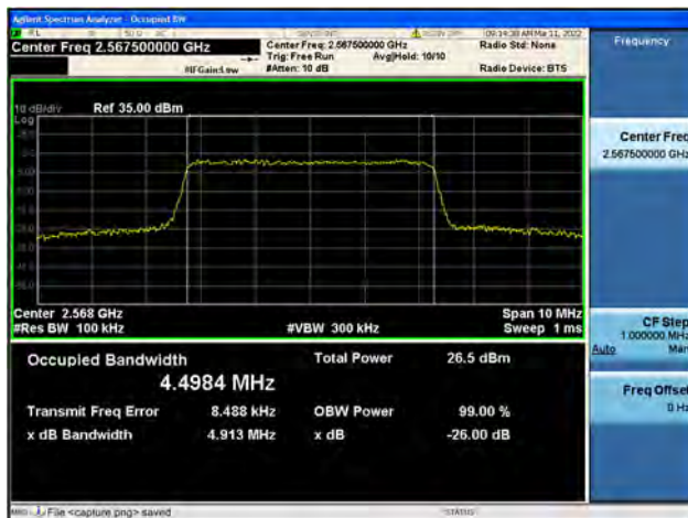
Band7 / 10MHz / Low CH / 16QAM
