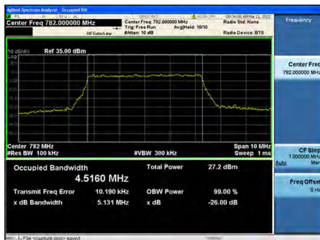
Band13 / 5MHz / Mid CH / 16QAM
