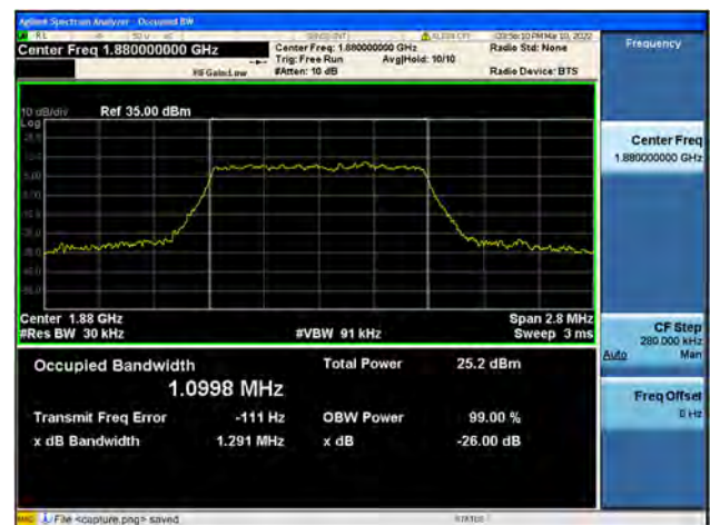
Band2 / 1.4MHz / Mid CH / 64QAM
