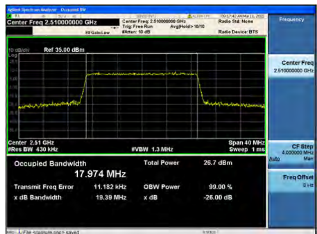
Band7 / 20MHz / Low CH / 64QAM
