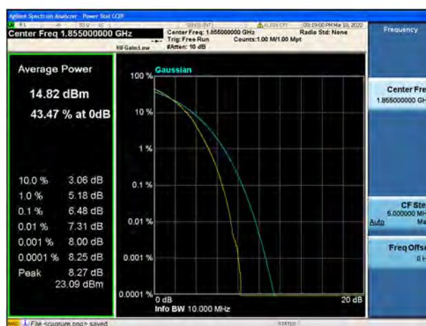
Band2 / 10MHz / Low CH / 64QAM
