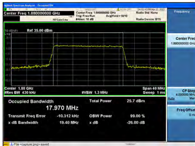
Band2 / 20MHz / High CH / 16QAM
