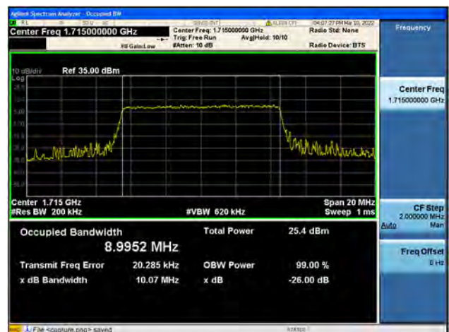
Band4 / 10MHz / Low CH / 64QAM
