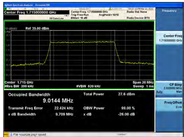
Band4 / 10MHz / Low CH / 64QAM
