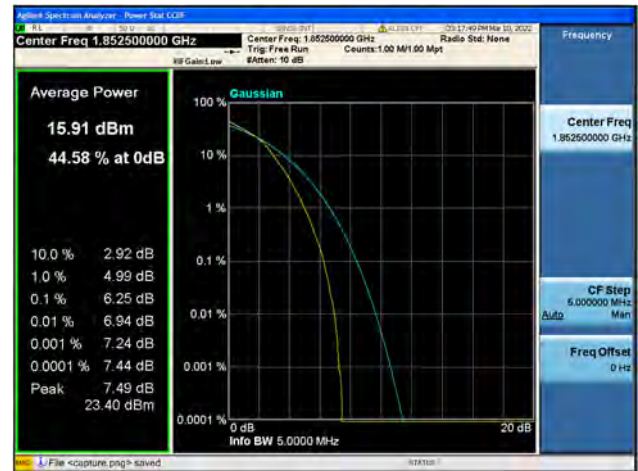
Band2 / 5MHz / Mid CH / QPSK
