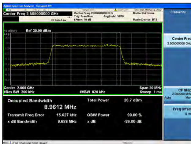
Band7 / 10MHz / Low CH / 16QAM
