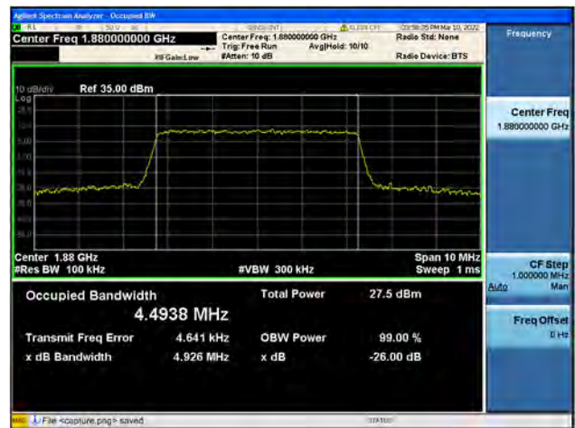
Band2 / 5MHz / Mid CH / 64QAM
