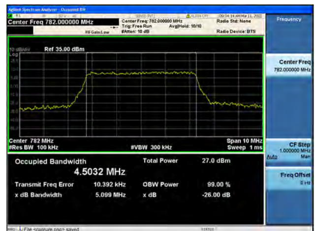
Band13 / 5MHz / Mid CH / 64QAM
