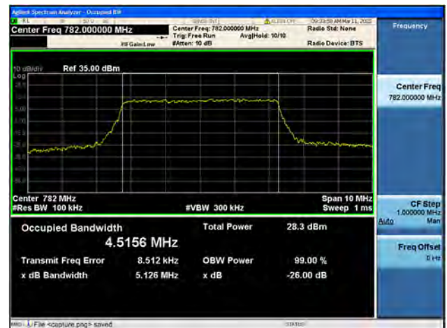
Band13 / 5MHz / Mid CH / 64QAM
