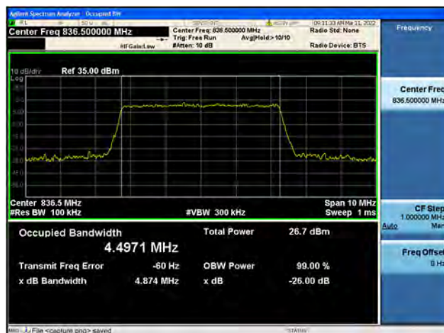
Band5 / 5MHz / Mid CH / 16QAM
