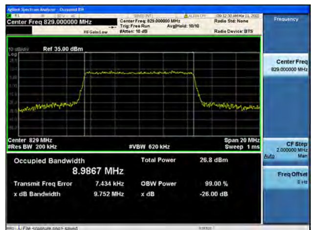
Band5 / 10MHz / Low CH / 64QAM
