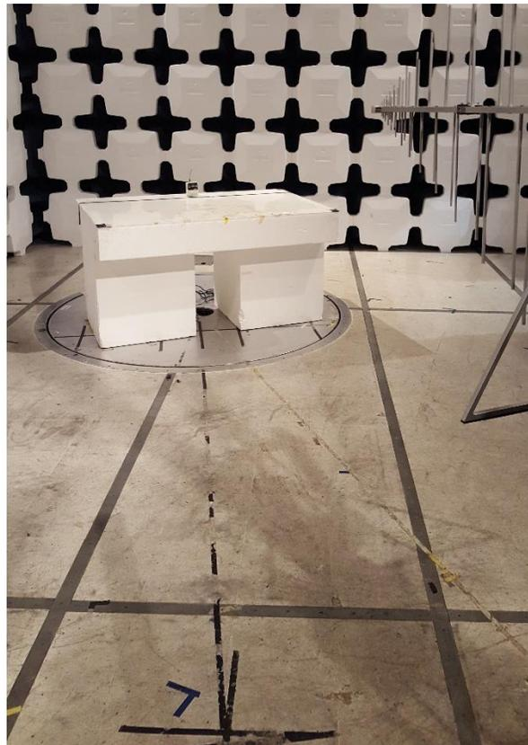
**Figure D-1. ULXD1-V50 Emission Setup**
