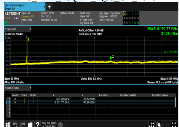
B5 1.4M 16QAM 1@0 CH 20407
