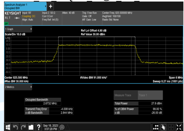
B5 3M 16QAM 15@0 CH 20525
