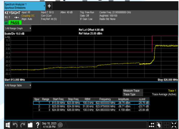
B5 5M 16QAM 25@0 CH 20425
