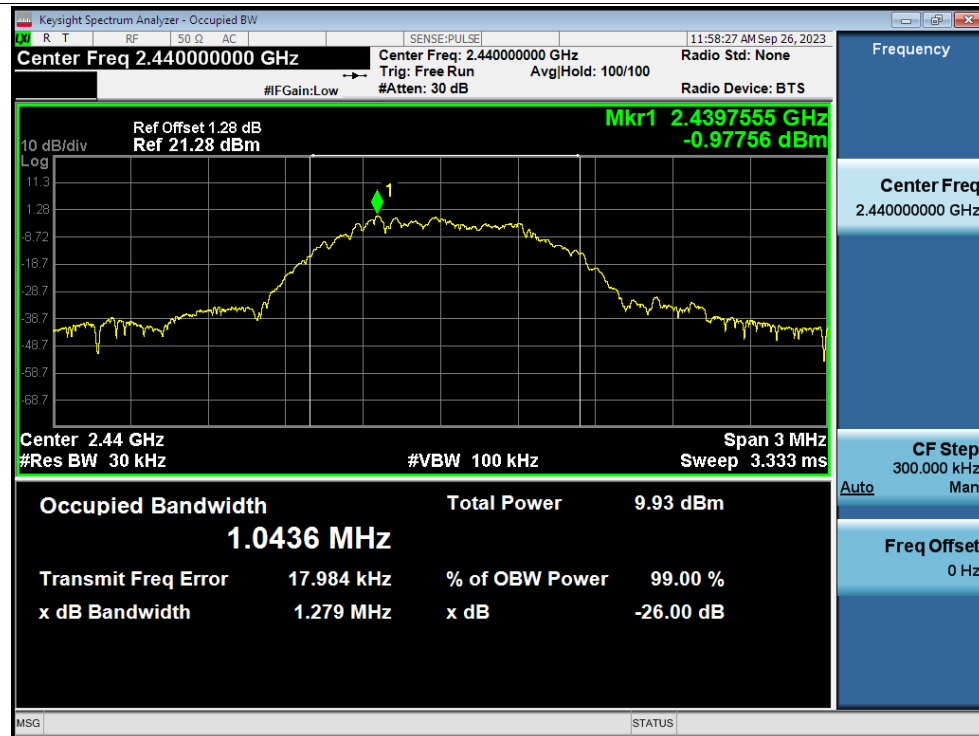
OBW NVNT BLE 1M 2440MHz Ant1
