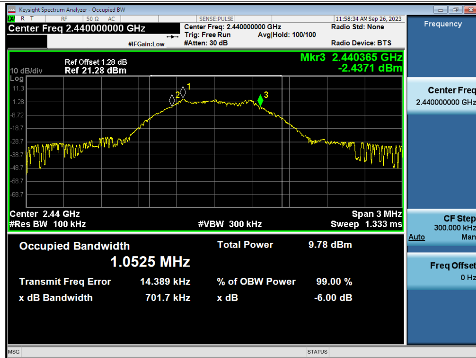
-6dB Bandwidth NVNT BLE 1M 2440MHz Ant1
