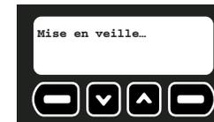
Lorsque l'appareil est en état de veille, le voyant DEL clignotera une fois toutes les 5 secondes. Pour remettre l'appareil en marche, brancher la base dans une prise murale.
