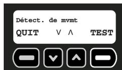
B. Pendant le test du détecteur de mouvements, un message sera affiché indiquant que l'appareil sonnera lorsqu'un détecteur de mouvements sera déclenché. Si l'appareil ne sonne pas, se reporter à la section **Guide de dépannage** pour plus de détails.
