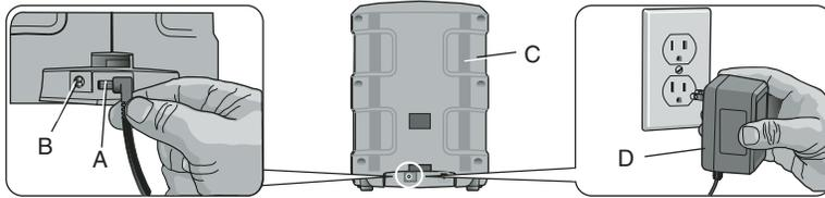
1. Connecter la fiche (A) du bloc d'alimentation à la prise (B) à l'arrière de la base (C).
