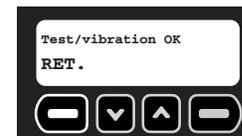
E. Utiliser les flèches vers le haut ou le bas pour faire défiler le menu jusqu'au prochain dispositif de console à tester.
