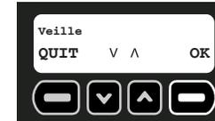
5. Cet écran rappellera que l'appareil doit être débranché avant d'être mis en veille. Débrancher le bloc d'alimentation puis choisir OK.
