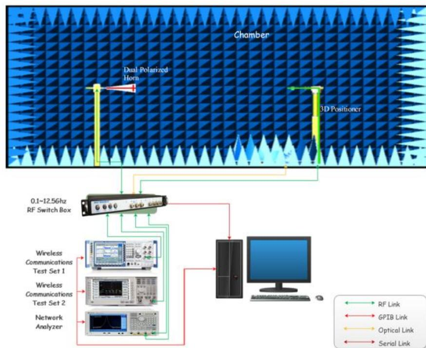
1.1.3 单探头测量系统 ( Single probe measurement system)
