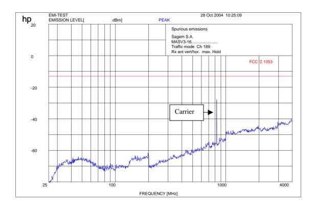
f < 1 GHz: RBW/VBW: 100 kHz  $f \ge 1 \text{ GHz}: RBW/VBW 1 \text{ MHz}$
