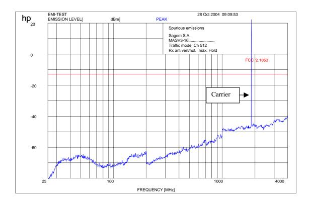
f < 1 GHz : RBW/VBW: 100 kHz  $f \ge 1 \text{ GHz} : RBW/VBW 1 \text{ MHz}$
