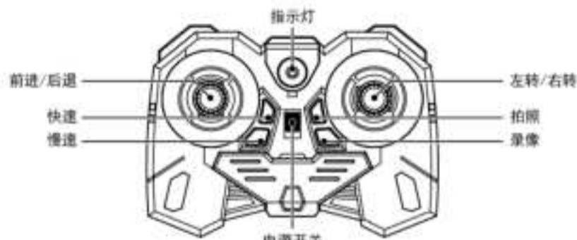
重新启动：当遥控车更换电池后，按下电源开关重新对频。
