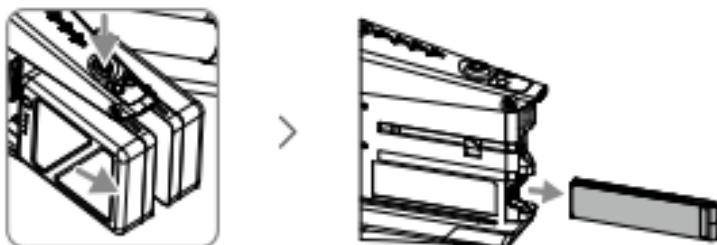
2. Вставьте CINESSD вчитывающее устройство DJI CINESSD. Подключите его к компьютеру с помощью входящего в комплект кабеля USB.
