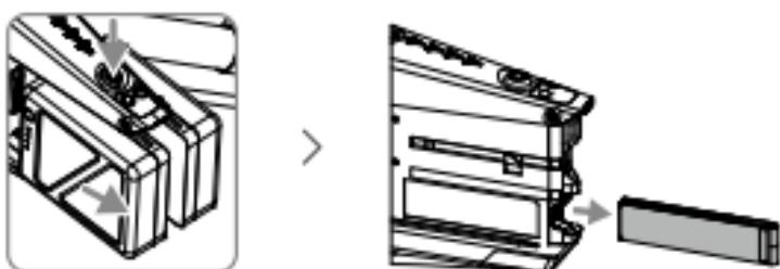
2. Inserte el CINESSD en la Estación DJI CINESSD y conecte la Estación a un ordenador mediante un cable USB.
