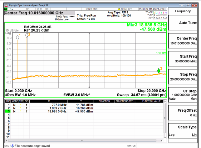
2A-12A / 20+10MHz / QPSK / High+High CH / 1@99-1@0
