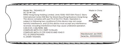
JOB: TAS4405/37 Serial No.Label 透明贴纸上丝印白色文字内容 SIZE: 20W x 5H mm 贴于HIPS塑胶面
