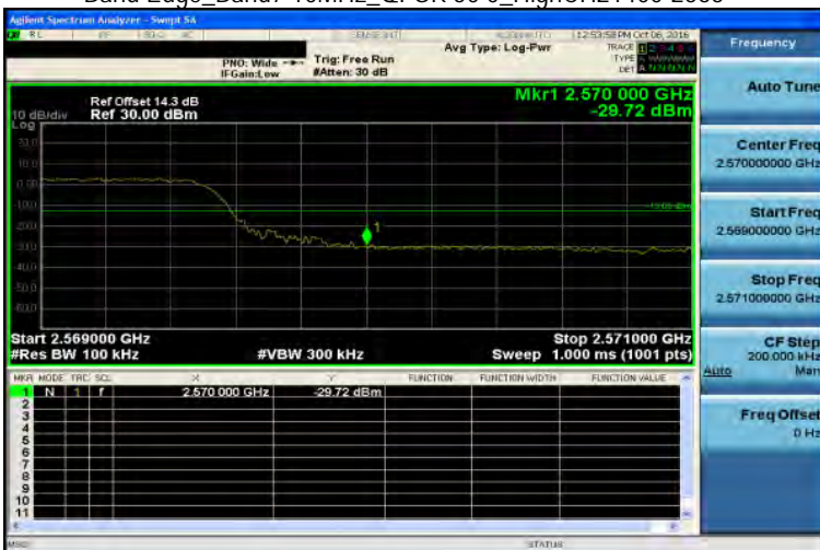
Band Edge_Band7 10MHz_QPSK 50 0_HighCH21400-2565
