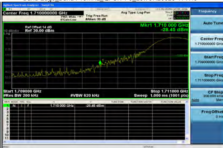
Band Edge_Band4 15MHz_QPSK 1 0_LowCH20025-1717.5
