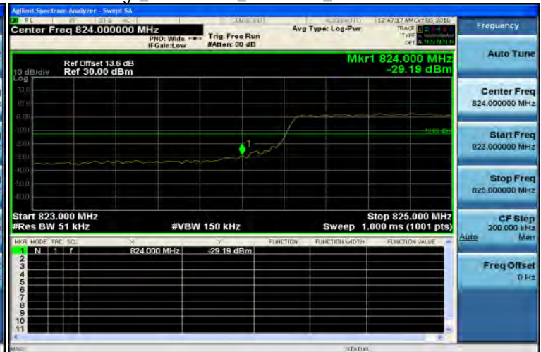
Band Edge_Band5 5MHz_QPSK 25 0_LowCH20425-826.5
