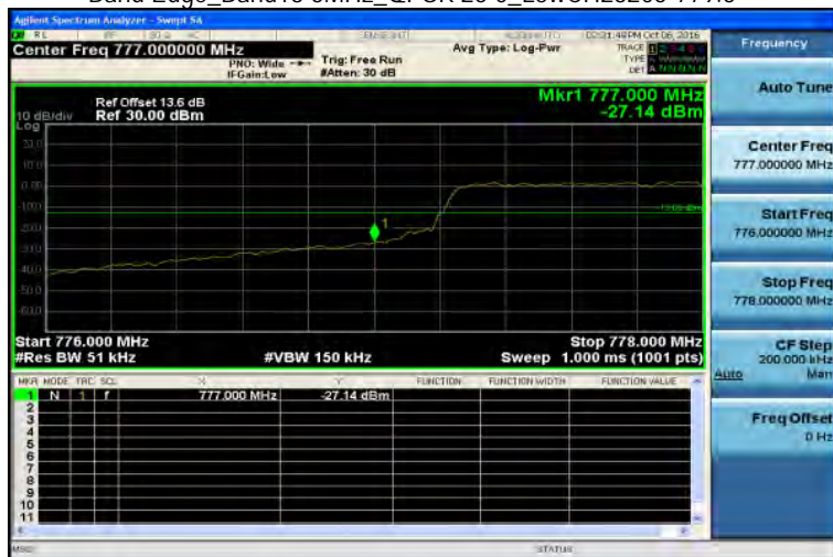
Band Edge_Band13 5MHz_QPSK 25 0_LowCH23205-779.5
