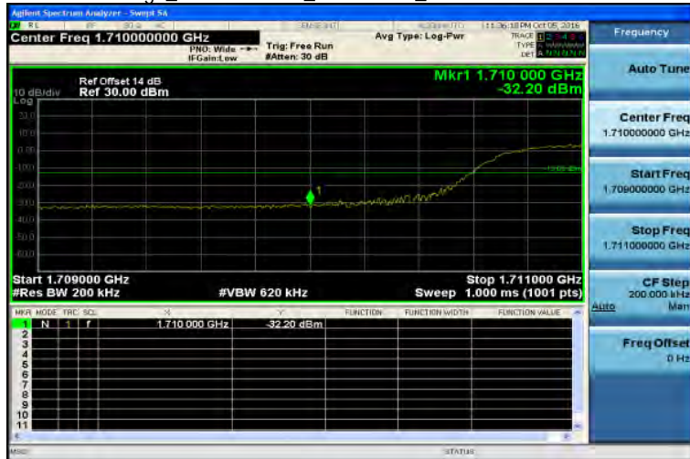
Band Edge_Band4 15MHz_QPSK 75 0_LowCH20025-1717.5
