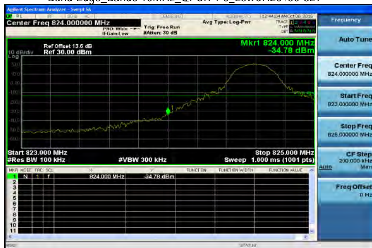
Band Edge_Band5 10MHz_QPSK 1 0_LowCH20450-829
