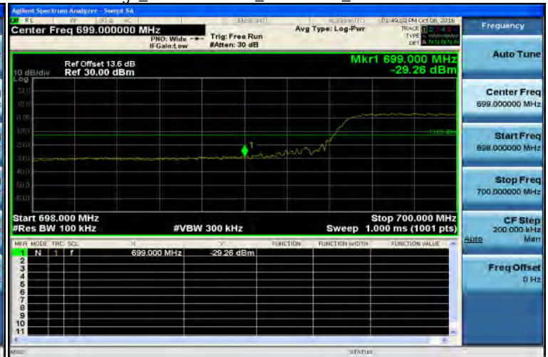
Band Edge_Band12 10MHz_QPSK 50 0_LowCH23060-704
