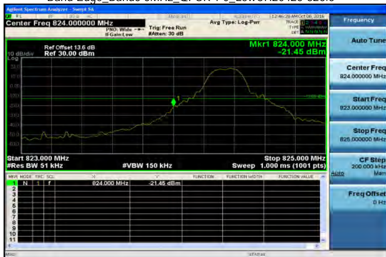
Band Edge_Band5 5MHz_QPSK 1 0_LowCH20425-826.5
