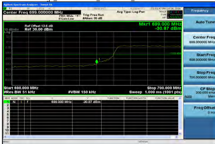
Band Edge_Band12 5MHz_QPSK 25 0_LowCH23035-701.5
