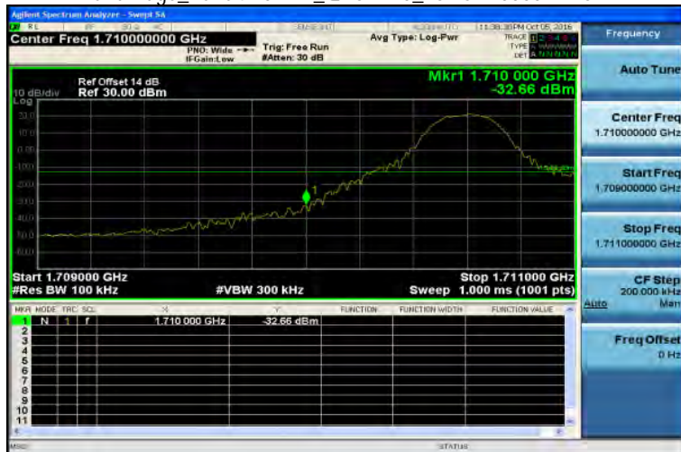
Band Edge_Band4 10MHz_QPSK 1 0_LowCH20000-1715
