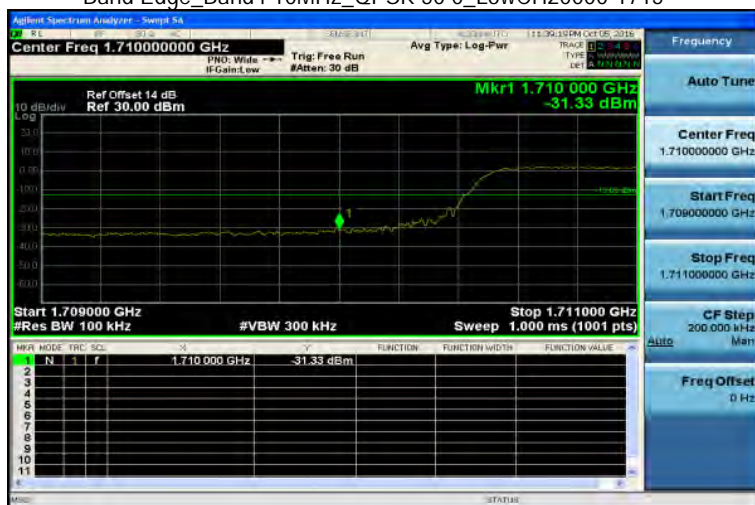
Band Edge_Band4 10MHz_QPSK 50 0_LowCH20000-1715
