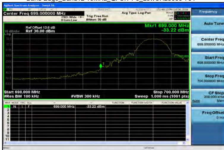
Band Edge_Band12 10MHz_QPSK 1 0_LowCH23060-704
