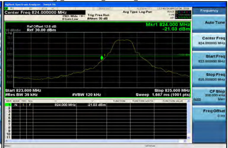
Band Edge_Band5 3MHz_QPSK 1 0_LowCH20415-825.5
