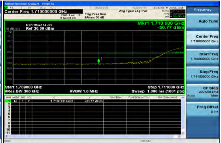
Band Edge_Band4 20MHz_QPSK 100 0_LowCH20050-1720
