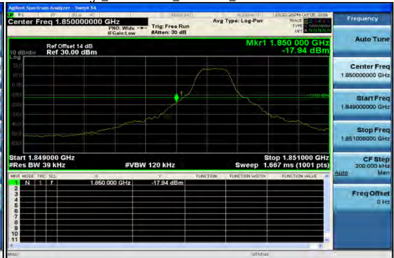
Band Edge_Band2 3MHz_QPSK 1 0_LowCH18615-1851.5
