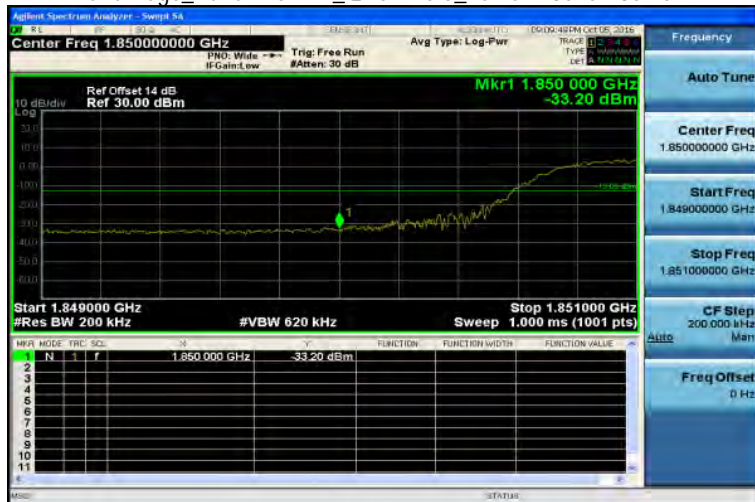
Band Edge_Band2 15MHz_QPSK 75 0_LowCH18675-1857.5
