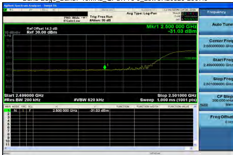
Band Edge_Band7 15MHz_QPSK 75 0_LowCH20825-2507.5
