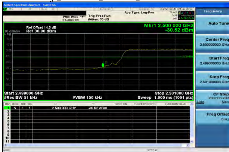
Band Edge_Band7 5MHz_QPSK 25 0_LowCH20775-2502.5
