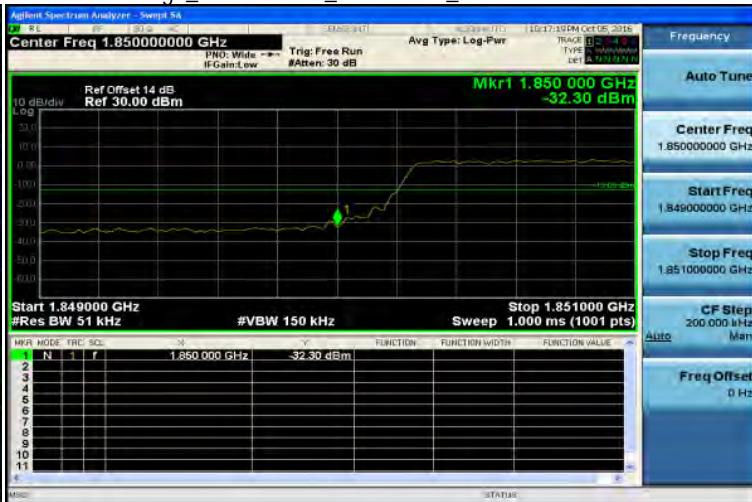
Band Edge_Band2 5MHz_QPSK 25 0_LowCH18625-1852.5
