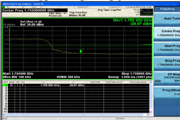
Band Edge_Band4 10MHz_QPSK 50 0_HighCH20350-1750
