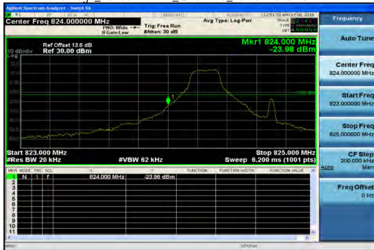
Band Edge_Band5 1.4MHz_QPSK 1 0_LowCH20407-824.7
