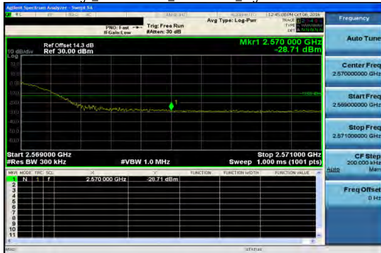
Band Edge_Band7 20MHz_QPSK 100 0_HighCH21350-2560
