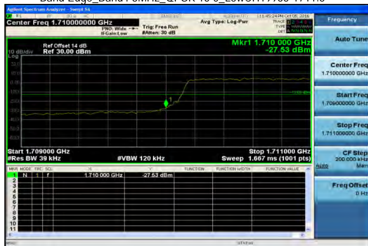
Band Edge_Band4 3MHz_QPSK 15 0_LowCH19965-1711.5
