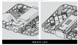
■ 将手置于无人机正下方20cm左右,无人机自动降落到手 掌并螺旋桨停止旋转
