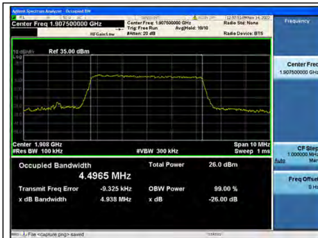
Band2 / 5MHz / QPSK/ High CH
