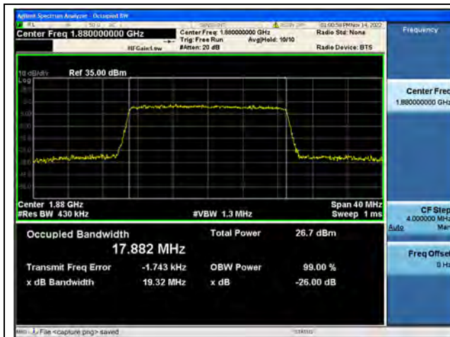
Band2 / 20MHz / QPSK/ Mid CH
