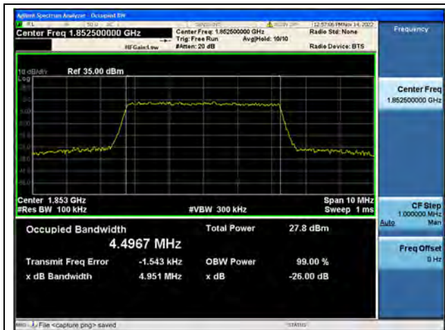
Band2 / 5MHz / QPSK/ Low CH
