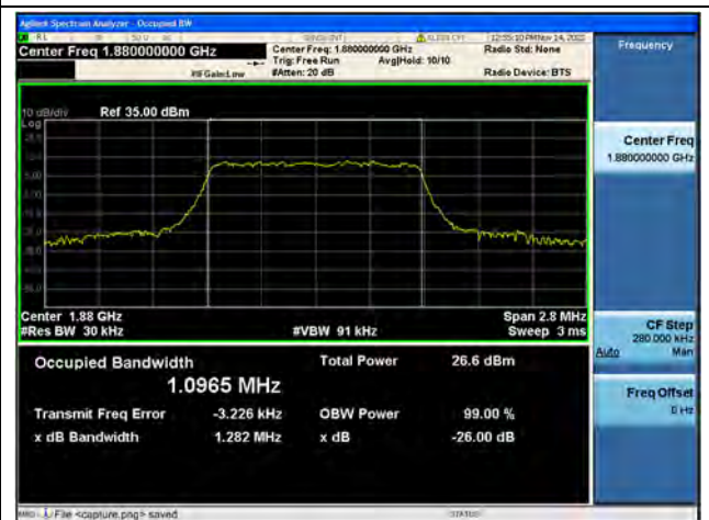
Band2 / 1.4MHz / QPSK/ Mid CH
