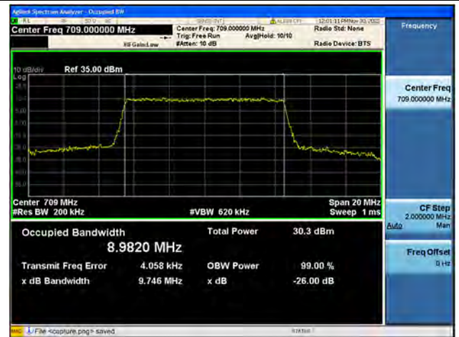
Band17 / 10MHz / QPSK/ Low CH
