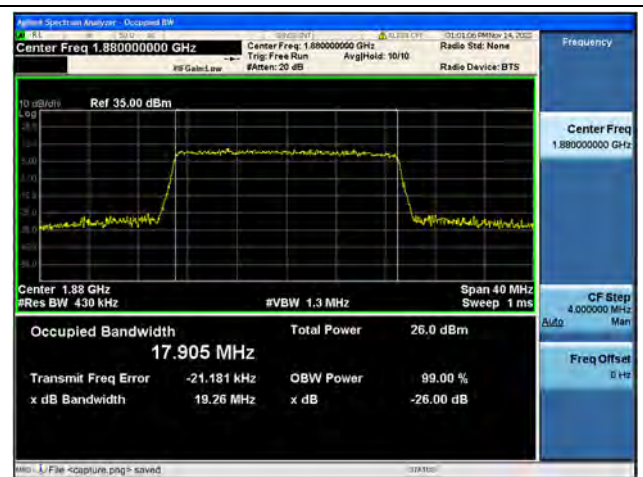
Band2 / 20MHz / 16QAM/ Mid CH
