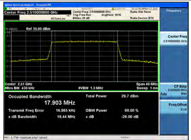
Band7 / 20MHz / QPSK/ Low CH
