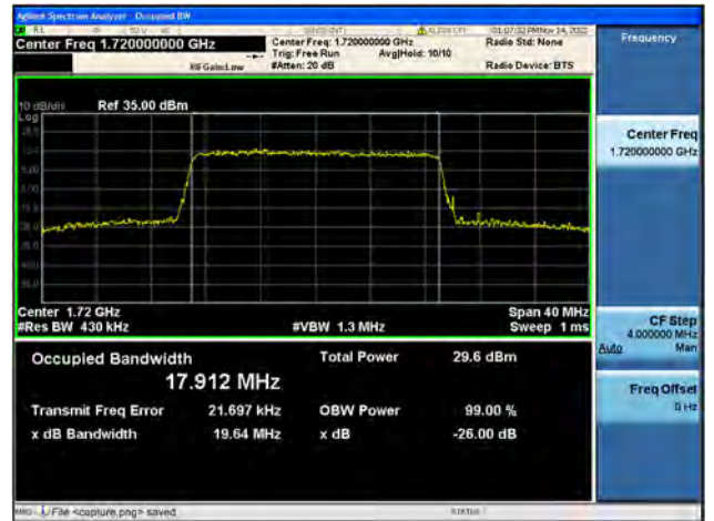
Band4 / 20MHz / QPSK/ Low CH
