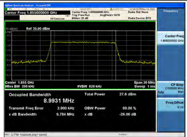
Band2 / 10MHz / QPSK/ Low CH
