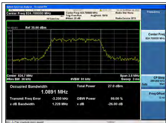
Band5 / 1.4MHz / QPSK/ Low CH
