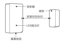
SNZB-04P是一款低功耗的无线门窗传感器,通过发射器与磁铁的靠近与分开感知门窗开/合状态,通过添加场景联动设置控制其它设备。
