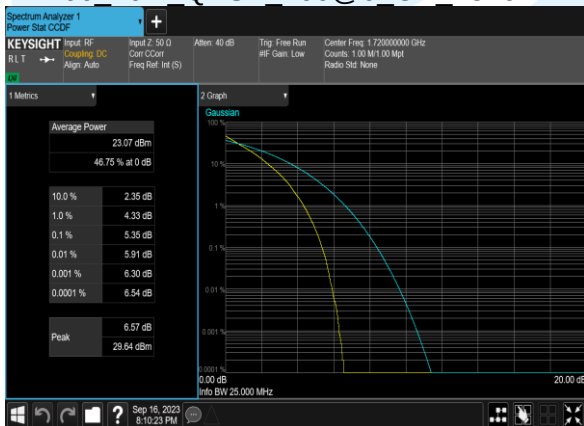
B66 20M QPSK 100@0 CH 132072
