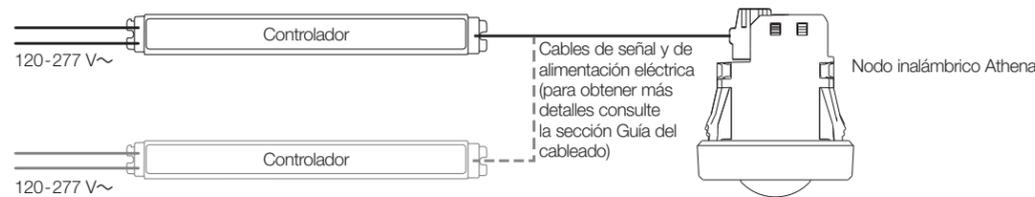
El nodo inalámbrico Athena controla hasta cinco controladores en función de la corriente de suministro. La norma IEC 62386 Parte 250 requiere una corriente de suministro mínima garantizada de 50 mA, con un máximo de 250 mA.
