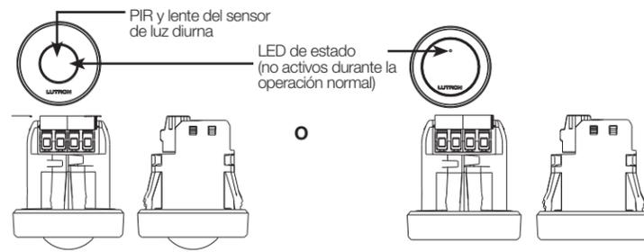
Nodo inalámbrico Athena con sensor (A-WN-D01-OCC)
