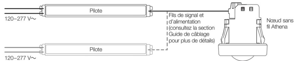
Le nœud sans fil Athena contrôle jusqu'à 5 pilotes en fonction du courant d'alimentation.
