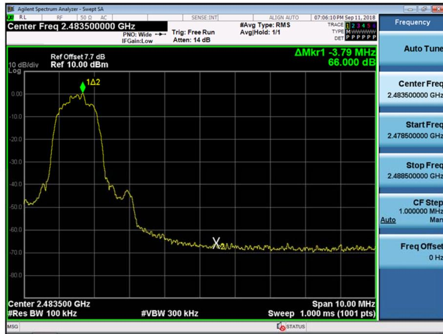
Test Plots without hopping ( $\pi/4$ DQPSK)
