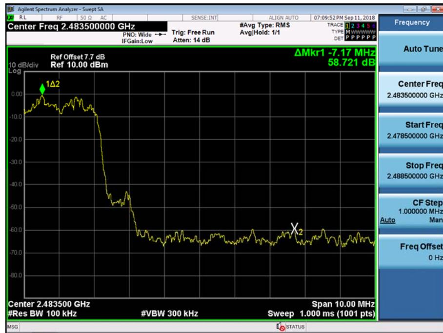
Test Plots with hopping ( $\pi/4$ DQPSK)
