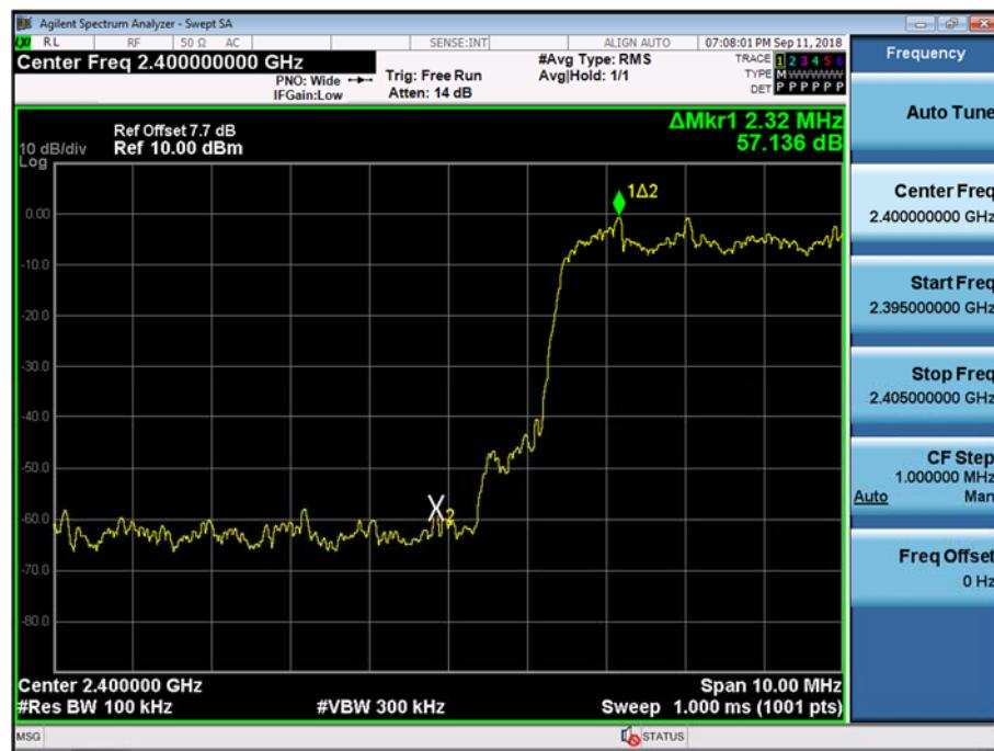
Test Plots with hopping ( $\pi/4$ DQPSK)
