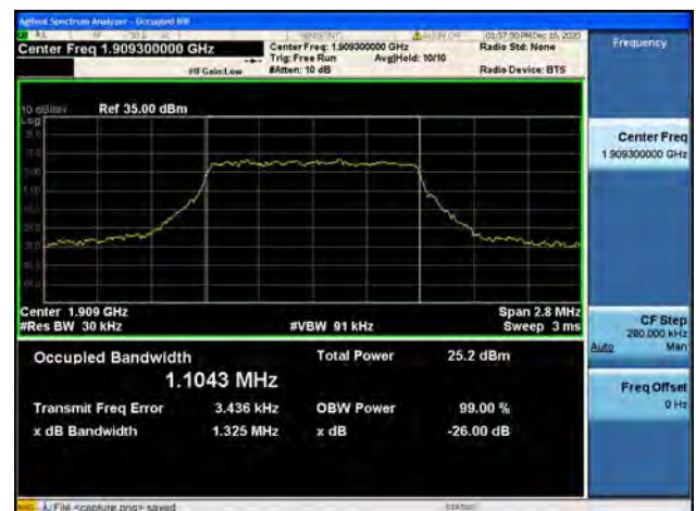
Band2 / 1.4MHz / High CH / 16QAM
