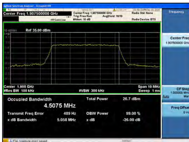
Band2 / 5MHz / High CH / QPSK
