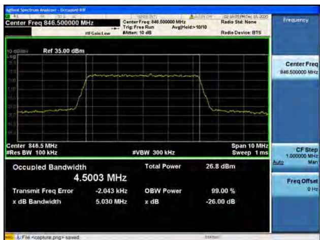
Band5 / 5MHz / High CH / QPSK
