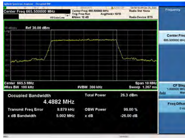
Band71 / 5MHz / Mid CH / QPSK
