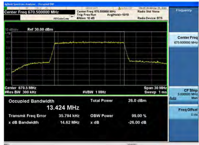
Band71 / 15MHz / Mid CH / 16QAM
