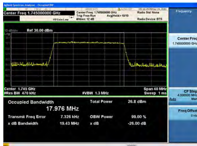
Band66 / 20MHz / High CH / QPSK
