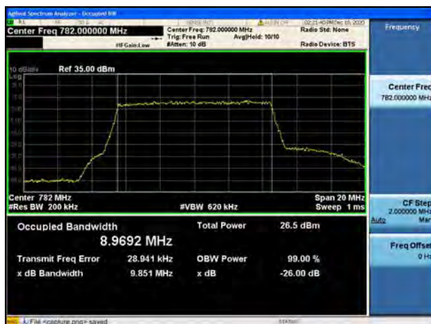
Band13 / 10MHz / High CH / QPSK
