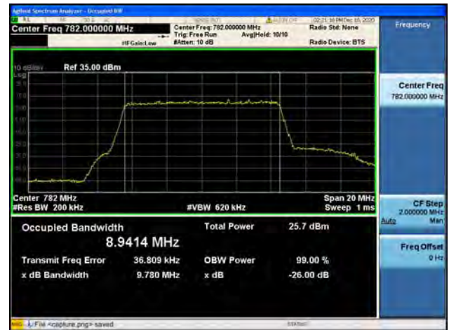
Band13 / 10MHz / Mid CH / 16QAM
