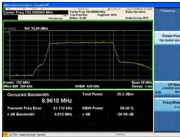
Band13 / 10MHz / High CH / QPSK
