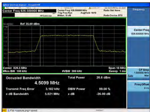
Band5 / 5MHz / Mid CH / QPSK
