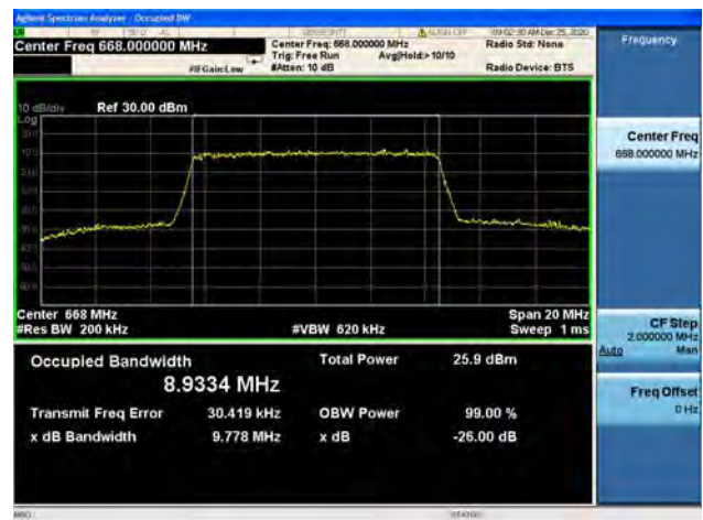
Band71 / 10MHz / Mid CH / 16QAM
