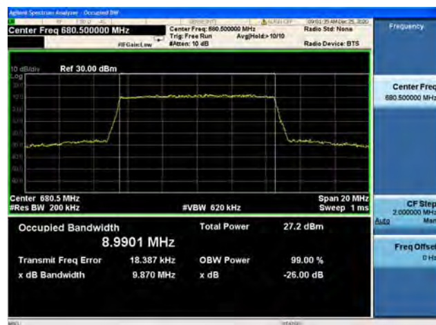
Band71 / 10MHz / High CH / QPSK
