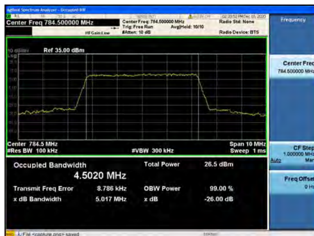
Band13 / 5MHz / High CH / QPSK
