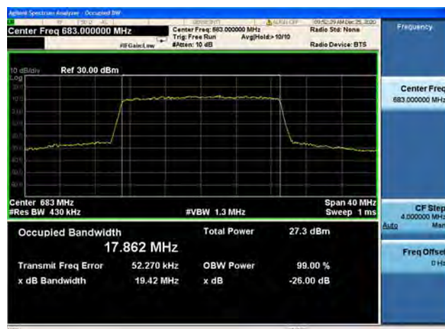
Band71 / 20MHz / High CH / QPSK
