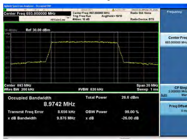
Band71 / 10MHz / High CH / QPSK
