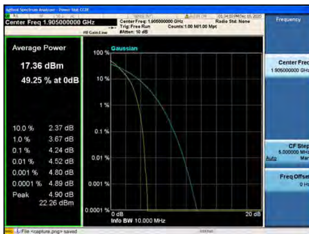
Band2 / 10MHz / High CH / QPSK
