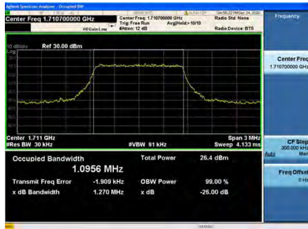
Band66 / 1.4MHz / Mid CH / QPSK
