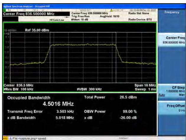
Band5 / 5MHz / High CH / QPSK
