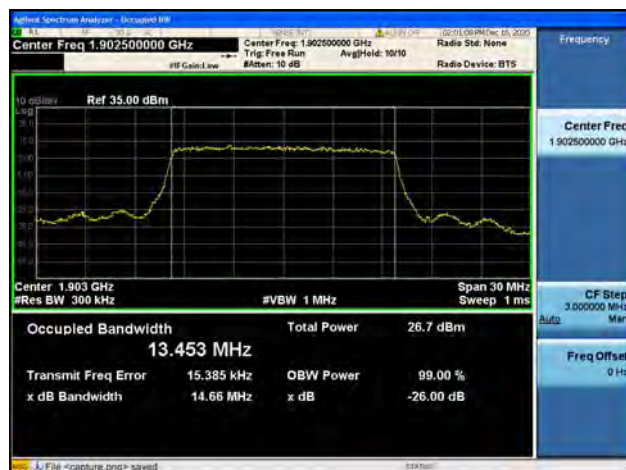
Band2 / 15MHz / High CH / QPSK
