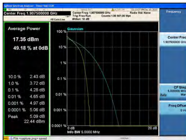
Band2 / 5MHz / High CH / QPSK
