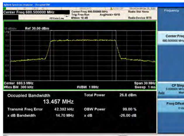
Band71 / 15MHz / High CH / QPSK
