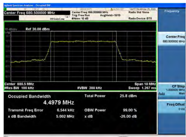
Band71 / 5MHz / High CH / 16QAM
