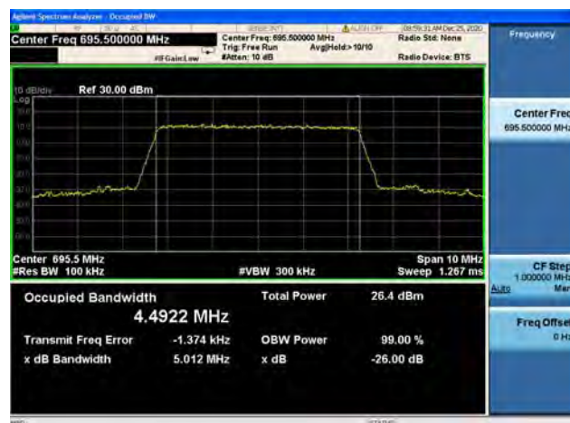
Band71 / 5MHz / High CH / QPSK
