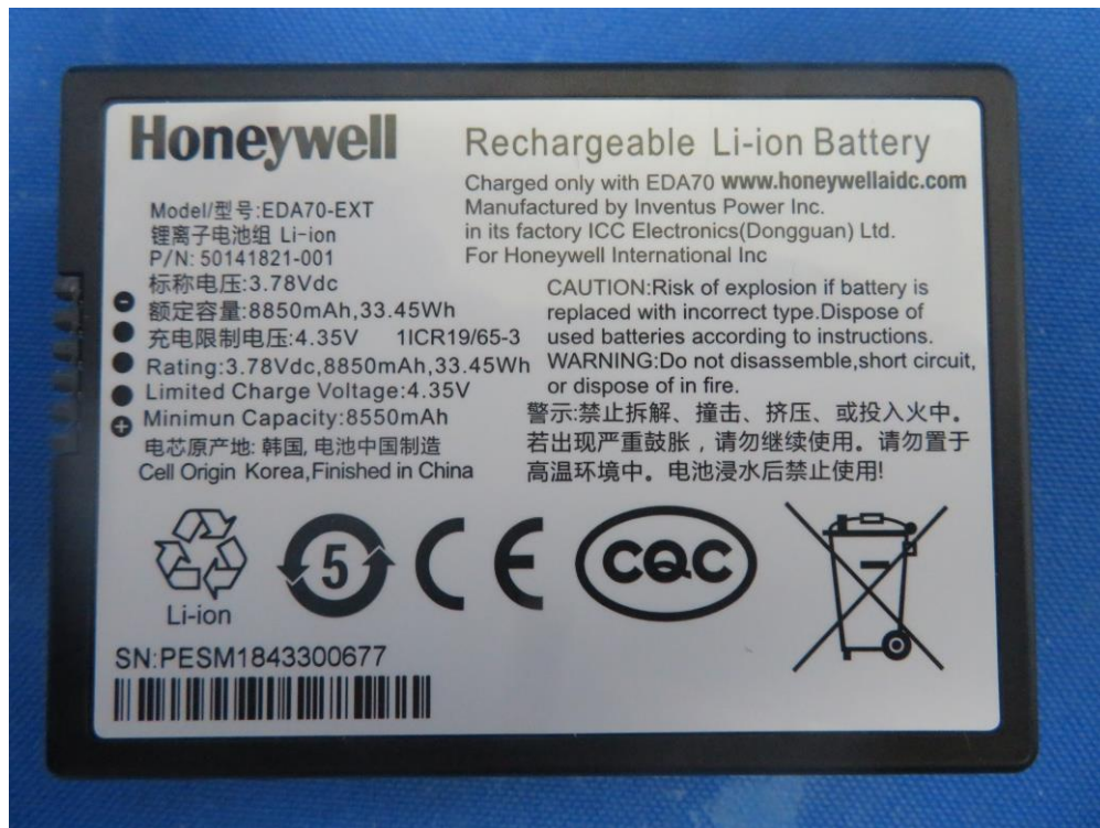
(15) EUT Photo (Battery 2#)
