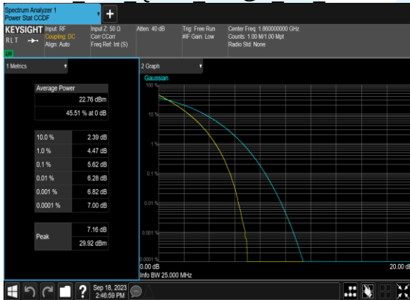
B25 20M QPSK 100@0 CH 26140
