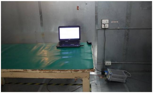
**RADIATED EMISSION TEST**
