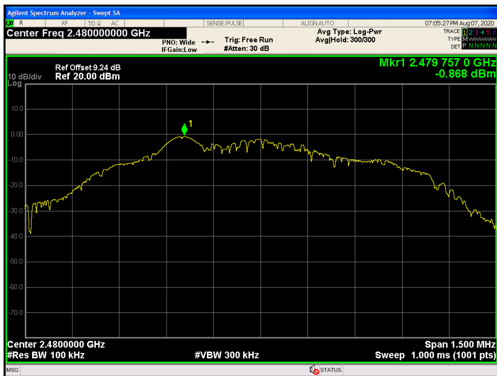
Tx. Spurious NVNT BLE 2480MHz Ant1 Emission
