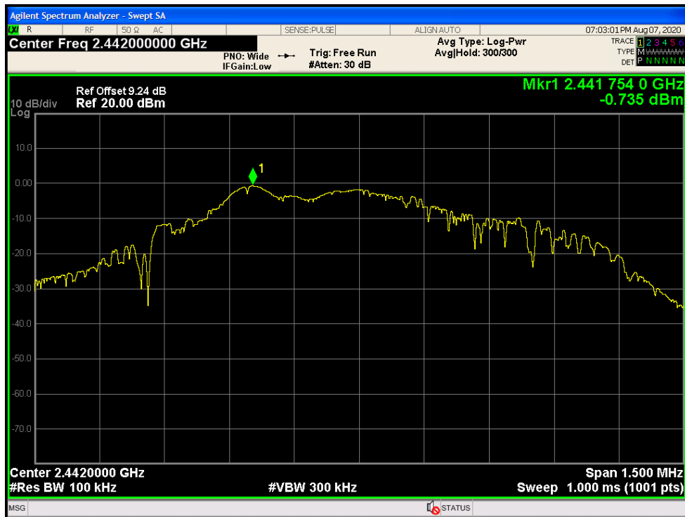
Tx. Spurious NVNT BLE 2442MHz Ant1 Emission
