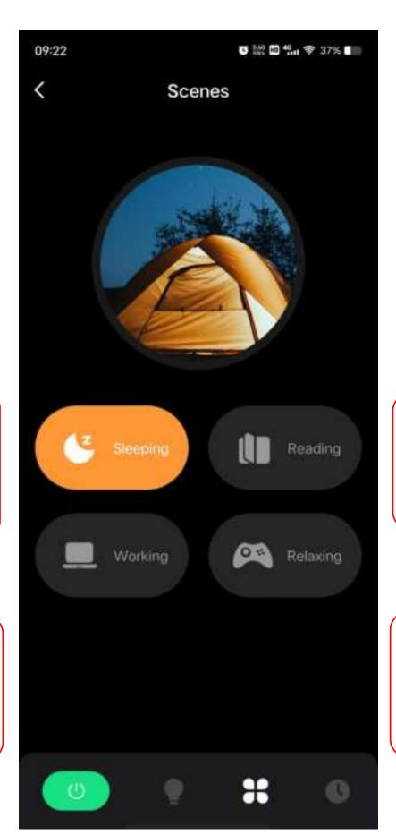
Sleeping PWM1(UVA):0 PWM2(B+TW):0 PWM3(BS+LED):0 PWM4(NT):100% PWM5(R):100%
