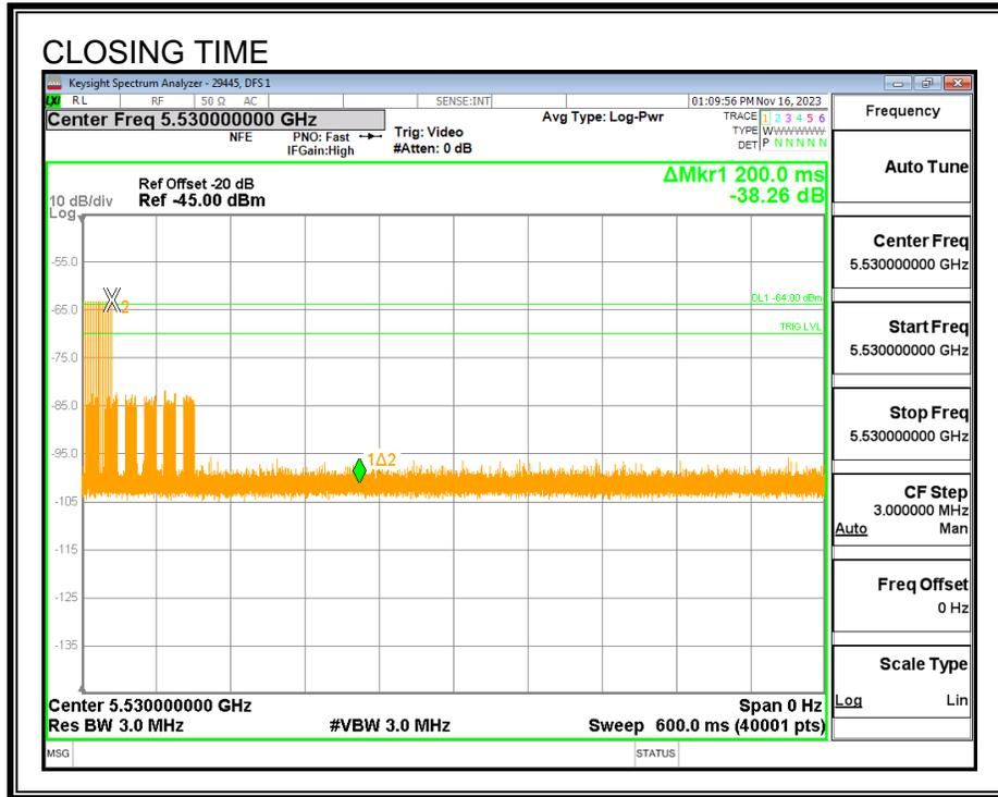
**AGGREGATE CHANNEL CLOSING TRANSMISSION TIME**
