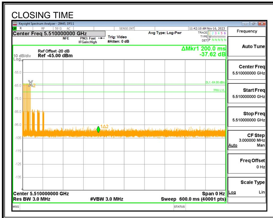
**AGGREGATE CHANNEL CLOSING TRANSMISSION TIME**
