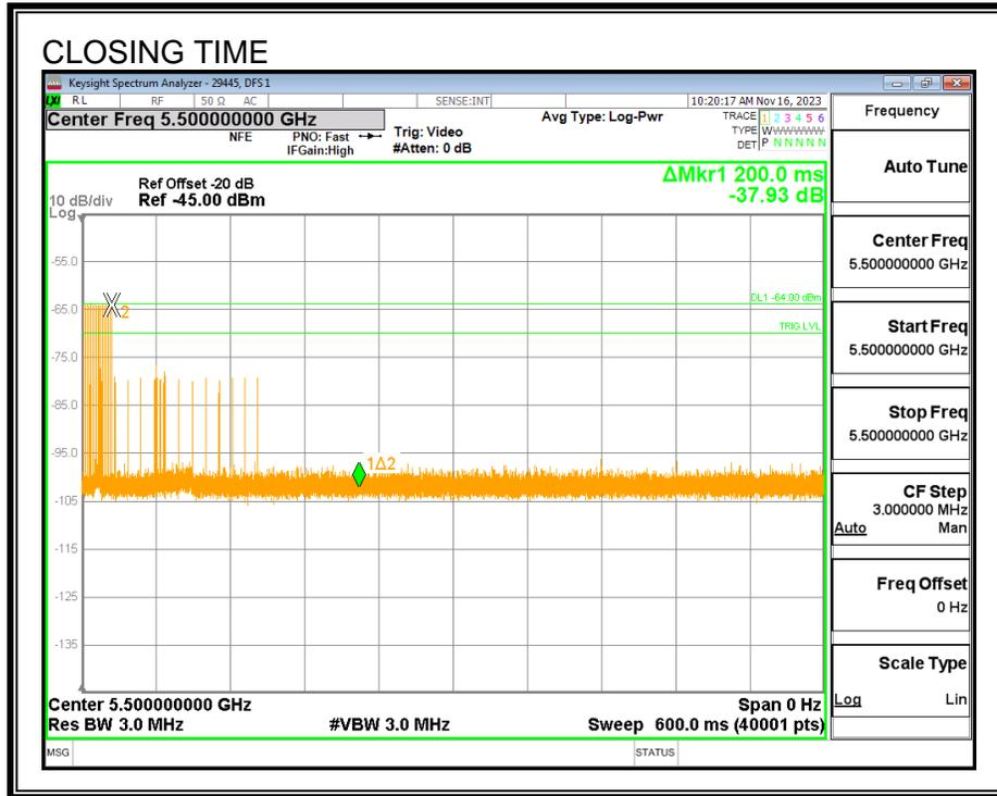
**AGGREGATE CHANNEL CLOSING TRANSMISSION TIME**
