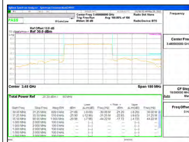
5G NR n77 60MHz BPSK Low Channel RB162-0
