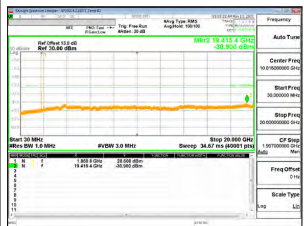
5G NR n25 20MHz BPSK Low Channel RB1-0
