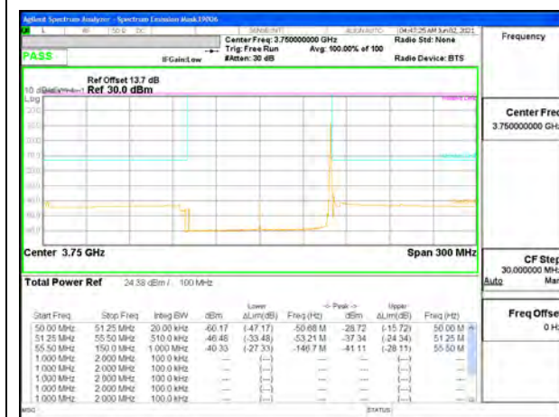
5G NR n77 100MHz BPSK Low Channel RB1-272
