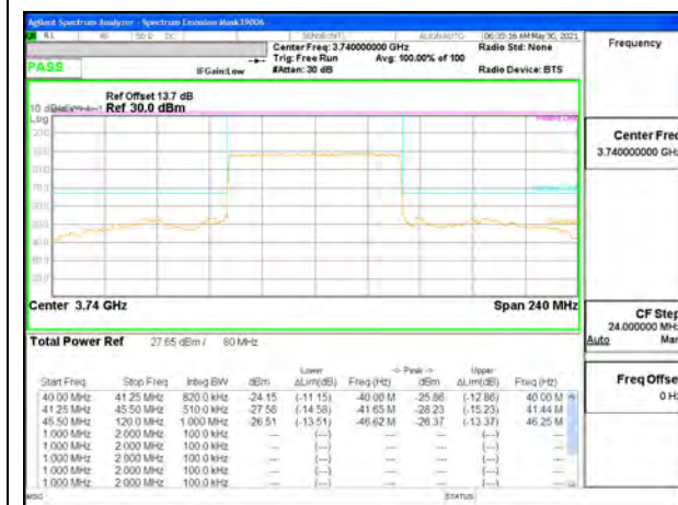
5G NR n77 80MHz BPSK Low Channel RB216-0
