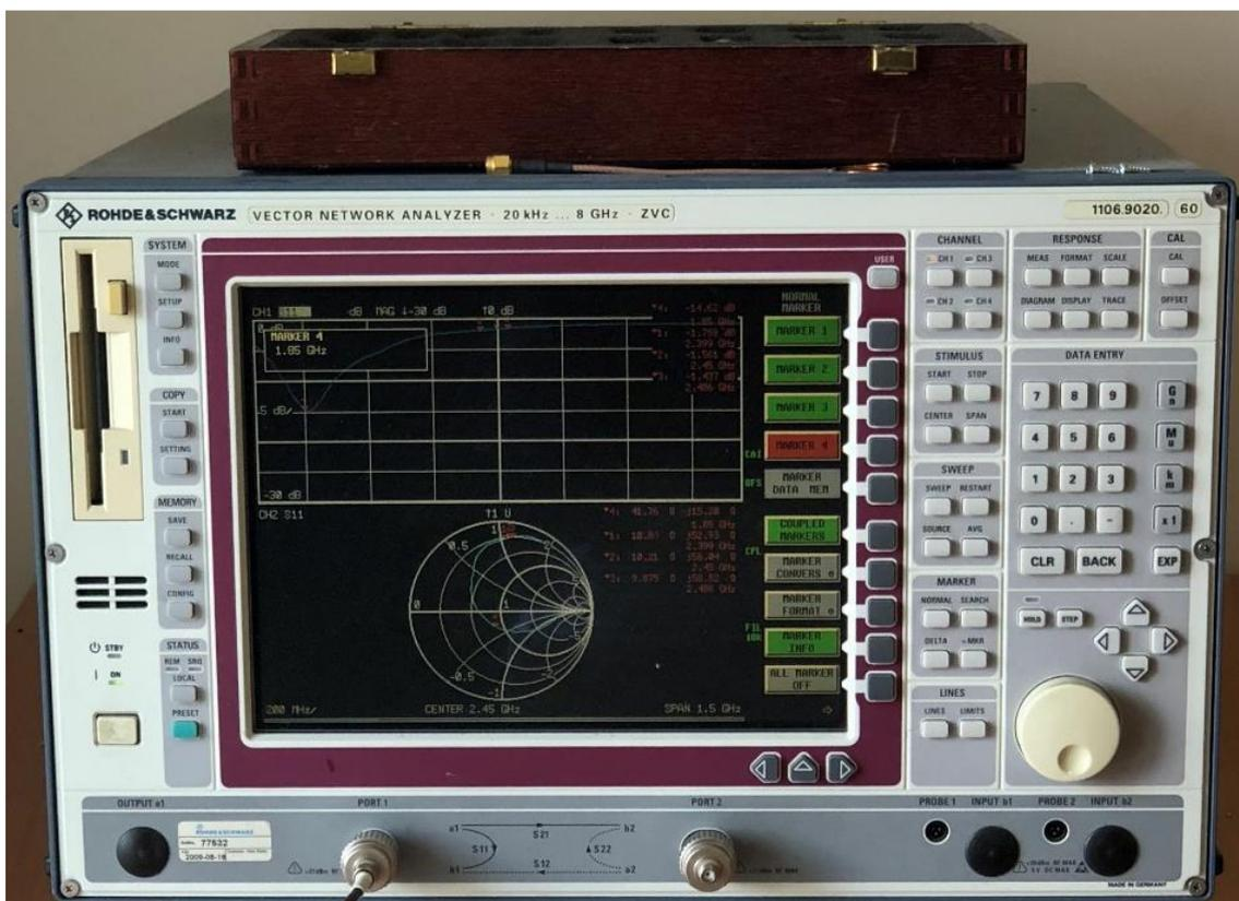
Exemple de mesure de paramètre S11
