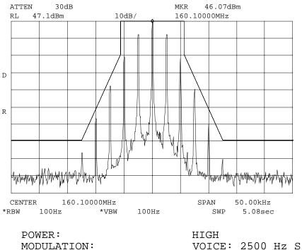
VOICE: 2500 Hz SINE WAVE MASK: D, VHF/UHF 12.5kHz BW
