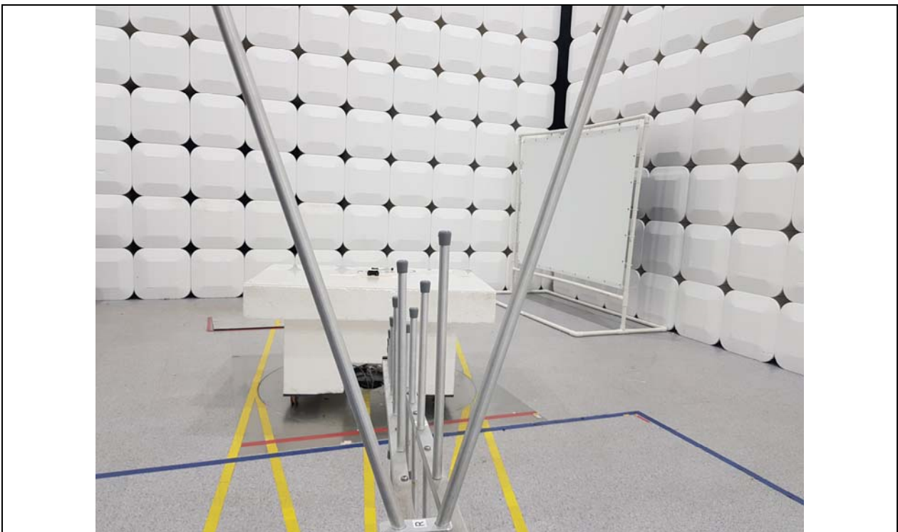
Test distance : 3 m, height of table : 0.8 m
