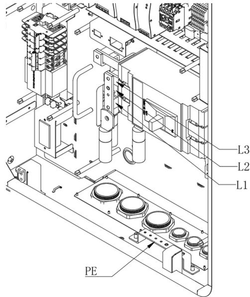
Figure 23. Wiring Diagram
