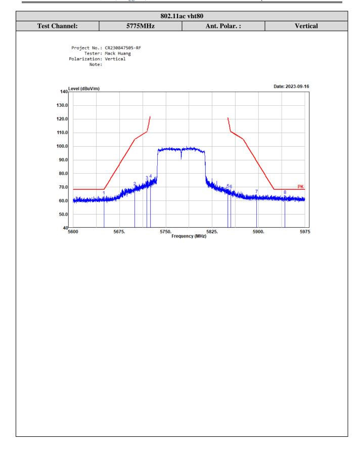
Worst Harmonic Margin Test plots(802.11ac vht80 5775MHz)
