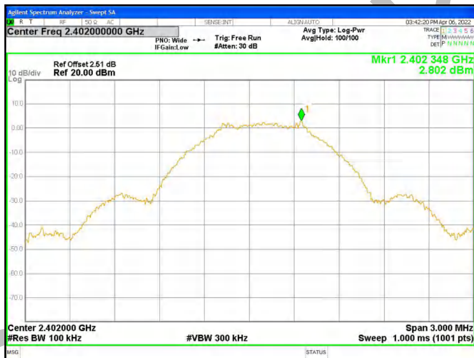
PSD NVNT BLE 1M 2442MHz Ant1
