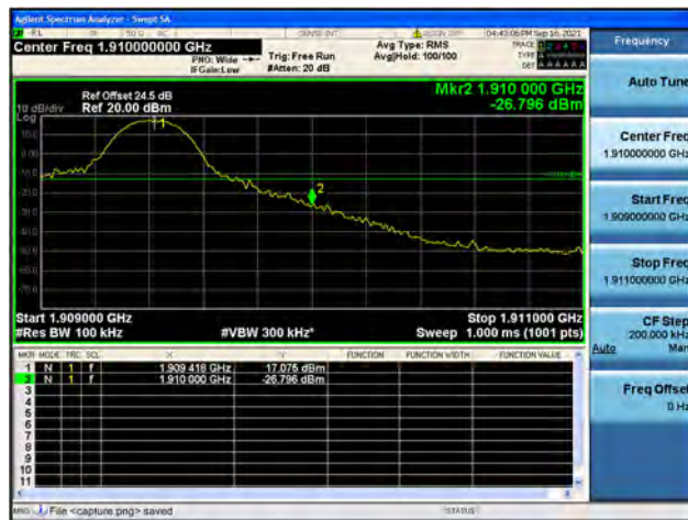
Band2 / 10MHz / High CH / QPSK / 1 RB
