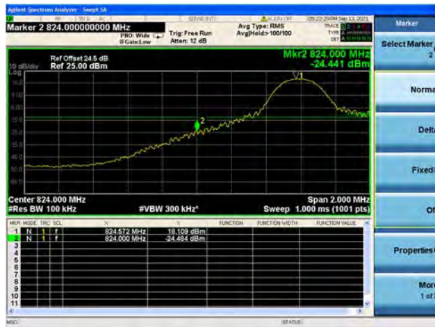
Band26 / 10MHz / High CH / QPSK / 1 RB
