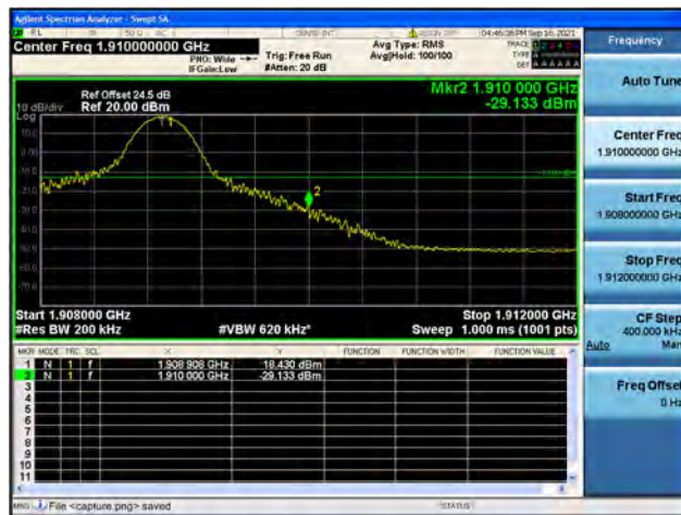
Band2 / 20MHz / High CH / QPSK / 1 RB
