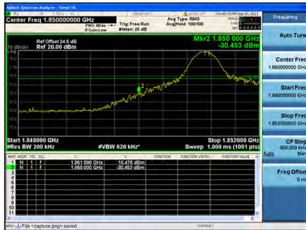
Band2 / 20MHz / High CH / QPSK / 1 RB
