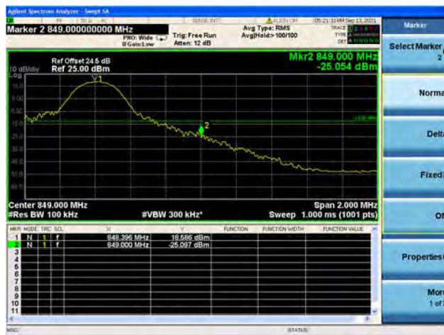
Band26 / 10MHz / High CH / QPSK / 1 RB
