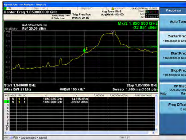
Band2 / 5MHz / High CH / QPSK / 1 RB
