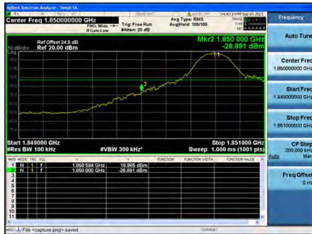
Band2 / 10MHz / High CH / QPSK / 1 RB
