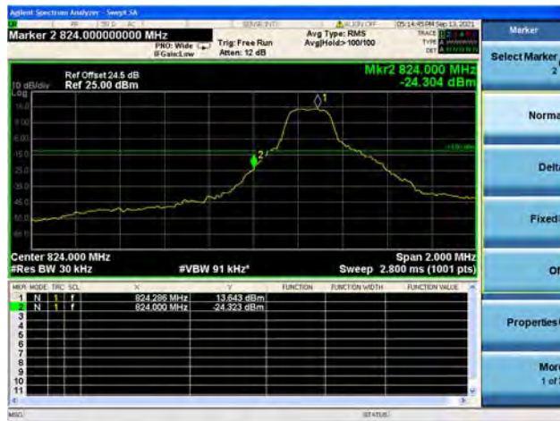
Band26 / 1.4MHz / High CH / QPSK / 1 RB
