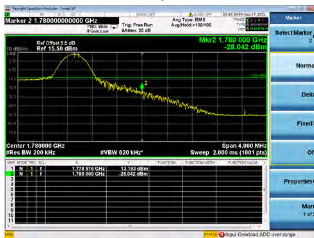
Band66 / 20MHz / High CH / QPSK / 1 RB
