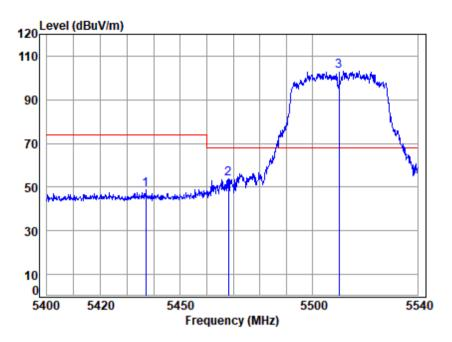
Site : chamber Condition: 3m VERTICAL : 00546AT/00547AT Mode : 5510 Band edge 5G WTFT 11N40 Note
