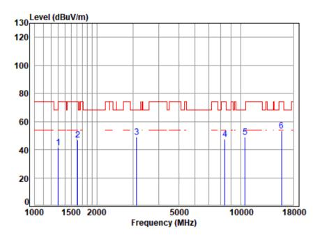
Site : chamber Condition: 3m VERTICAL Job No : 00546AT/00547AT Mode : 5260 TX RSE · 5G WTFT 11ΔX20 Note
