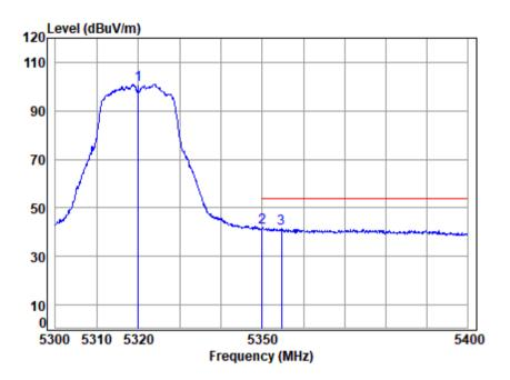
Site : chamber Condition: 3m VERTICAL : 00546AT/00547AT Mode : 5320 Band edge : 5G WIFI 11AC20 Note
