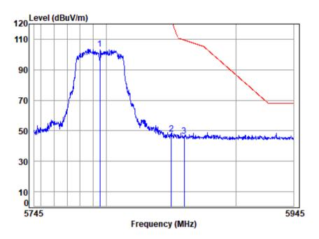
Site : chamber Condition: 3m VERTICAL Job No : 00546AT/00547AT : 5795 Band edge Mode : 5G WIFI 11N40 Note
