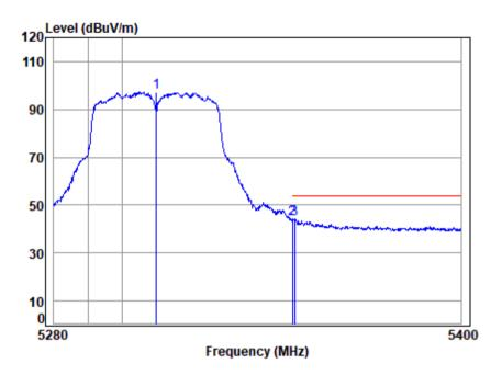
Site : chamber Condition: 3m VERTICAL Job No : 00546AT/00547AT Mode : 5310 Band edge : 5G WIFI 11N40 Note
