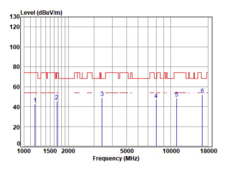
Site : chamber Condition: 3m VERTICAL Job No : 00546AT/00547AT Mode : 5500 TX RSE · 5G WTFT 11ΔX20 Note
