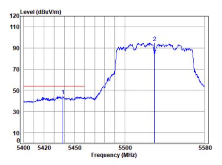
Site : chamber Condition: 3m VERTICAL : 00546AT/00547AT Mode : 5530 Band edge : 5G WTFT 11AC80 Note
