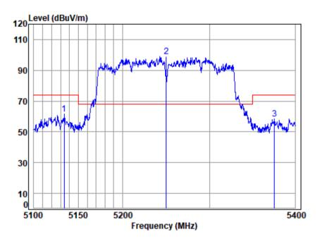
Site : chamber Condition: 3m VERTICAL : 00546AT/00547AT : 5250 Band edge Mode : 5G WIFI 11AC160 Note
