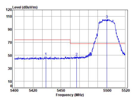
Site : chamber Condition: 3m VERTICAL Job No : 00546AT/00547AT Mode : 5500 Band edge : 5G WIFI 11AC20 Note
