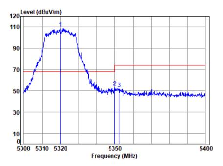
: chamber Site Condition: 3m VERTICAL : 00546AT/00547AT Mode : 5320 Band edge : 5G WTFT 11AC20 Note
