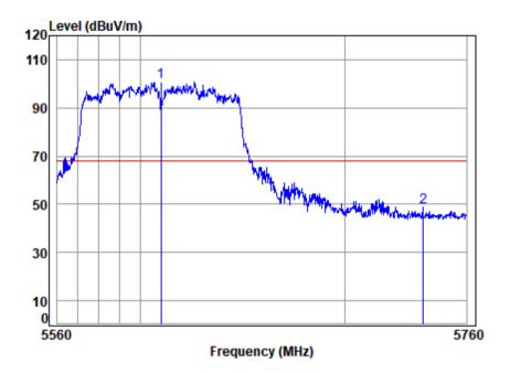
Site : chamber Condition: 3m VERTICAL : 00546AT/00547AT Mode : 5610 Band edge : 5G WTFT 11AC80 Note
