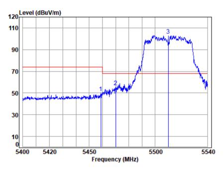
Site : chamber Condition: 3m VERTICAL : 00546AT/00547AT Mode : 5510 Band edge • 5G WTFT 11ΔC40 Note
