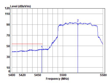
Site : chamber Condition: 3m VERTICAL : 00546AT/00547AT Mode : 5530 Band edge · 5G WTFT 11ΔX80 Note
