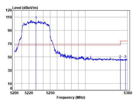
Site : chamber Condition: 3m VERTICAL Job No : 00546AT/00547AT : 5230 Band edge Mode : 5G WIFI 11AX40 Note
