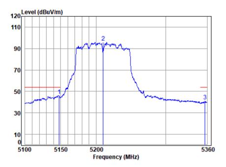
Site : chamber Condition: 3m VERTICAL : 00546AT/00547AT Mode : 5210 Band edge : 5G WIFI 11AC80 Note
