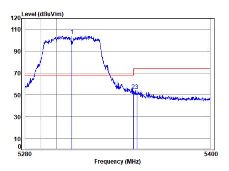
Site : chamber Condition: 3m VERTICAL Job No : 00546AT/00547AT Mode : 5310 Band edge 5G WTFT 11N40 Note
