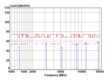
Site : chamber Condition: 3m VERTICAL Job No : 00546AT/00547AT Mode : 5785 TX RSE · 5G WTFT 11ΔX20 Note
