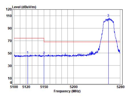
Site : chamber Condition: 3m VERTICAL : 00546AT/00547AT Mode : 5260 Band edge : 5G WIFI 11AC20 Note
