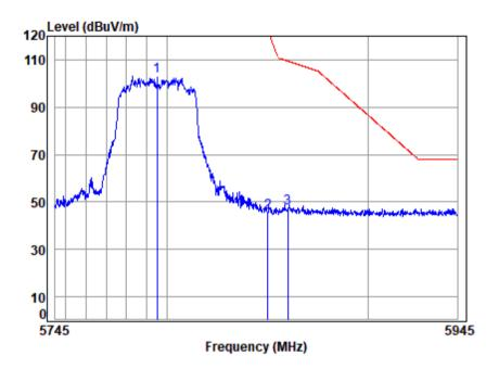
Site : chamber Condition: 3m VERTICAL Job No : 00546AT/00547AT : 5795 Band edge Mode : 5G WIFI 11AX40 Note
