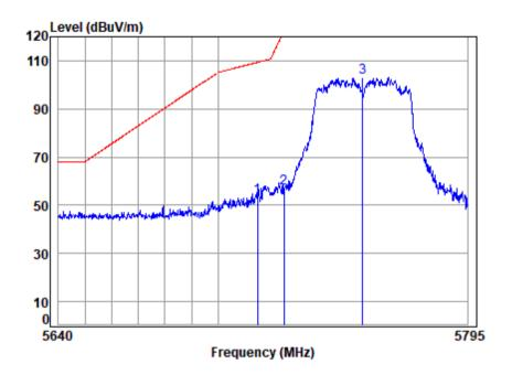
Site : chamber Condition: 3m VERTICAL Job No : 00546AT/00547AT Mode : 5755 Band edge · 5G WTFT 11ΔC40 Note
