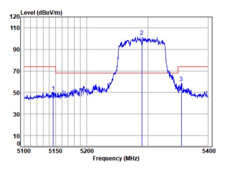
Site : chamber Condition: 3m VERTICAL : 00546AT/00547AT Mode : 5290 Band edge : 5G WTFT 11AC80 Note
