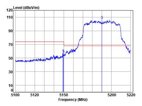
Site : chamber Condition: 3m VERTICAL : 00546AT/00547AT Mode : 5190 Band edge : 5G WIFI 11AX40 Note
