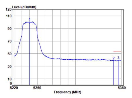
Site : chamber Condition: 3m VERTICAL : 00546AT/00547AT Mode : 5240 Band edge : 5G WIFI 11AC20 Note
