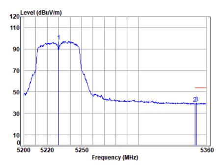
Site : chamber Condition: 3m VERTICAL : 00546AT/00547AT Mode : 5230 Band edge : 5G WIFI 11N40 Note
