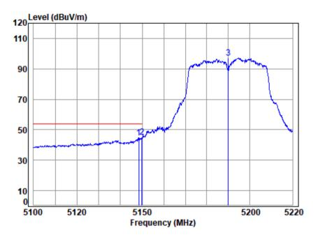
Site : chamber Condition: 3m VERTICAL : 00546AT/00547AT Mode : 5190 Band edge : 5G WIFI 11N40 Note
