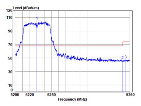
Site : chamber Condition: 3m VERTICAL Job No : 00546AT/00547AT Mode : 5230 Band edge : 5G WTFT 11N40 Note
