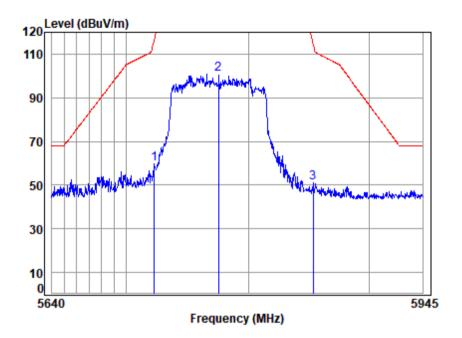
Site : chamber Condition: 3m VERTICAL Job No : 00546AT/00547AT Mode : 5775 Band edge : 5G WIFI 11AX80 Note
