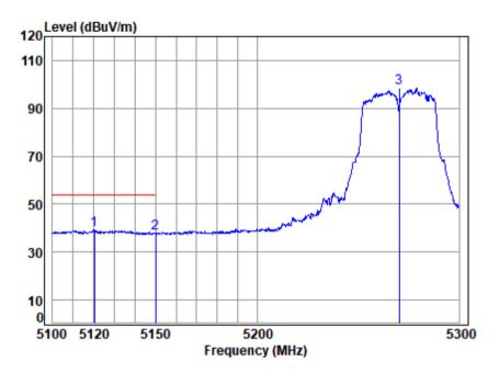
Site : chamber Condition: 3m VERTICAL : 00546AT/00547AT Mode : 5270 Band edge : 5G WIFI 11N40 Note
