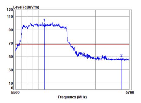
Site : chamber Condition: 3m VERTICAL Job No : 00546AT/00547AT : 5610 Band edge Mode : 5G WIFI 11AX80 Note
