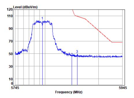
Site : chamber Condition: 3m VERTICAL : 00546AT/00547AT : 5795 Band edge Mode : 5G WIFI 11AC40 Note
