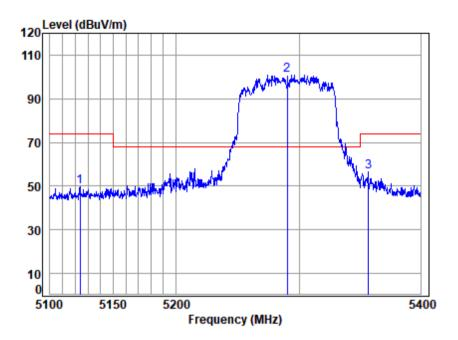
Site : chamber Condition: 3m VERTICAL : 00546AT/00547AT Mode : 5290 Band edge : 5G WIFI 11AX80 Note
