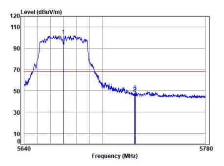
Site : chamber Condition: 3m VERTICAL : 00546AT/00547AT Mode : 5670 Band edge : 5G WIFI 11AC40 Note
