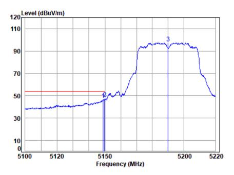
Site : chamber Condition: 3m VERTICAL Job No : 00546AT/00547AT Mode : 5190 Band edge • 5G WTFT 11ΔΧΔΘ Note
