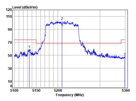
Site : chamber Condition: 3m VERTICAL : 00546AT/00547AT Mode : 5210 Band edge : 5G WTFT 11AC80 Note
