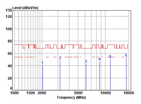
Site : chamber Condition: 3m VERTICAL Job No : 00546AT/00547AT Mode : 5700 TX RSE · 5G WTFT 11Δ Note
