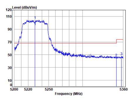
Site : chamber Condition: 3m VERTICAL Job No : 00546AT/00547AT Mode : 5230 Band edge : 5G WIFI 11AC40 Note
