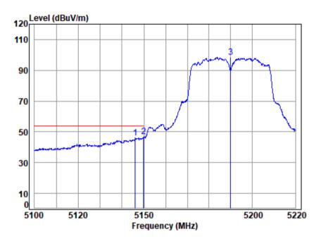
Site : chamber Condition: 3m VERTICAL : 00546AT/00547AT Mode : 5190 Band edge : 5G WTFT 11AC40 Note
