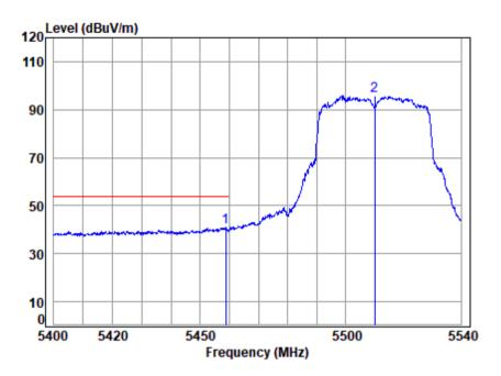
Site : chamber Condition: 3m VERTICAL Job No : 00546AT/00547AT Mode : 5510 Band edge : 5G WTFT 11AX40 Note
