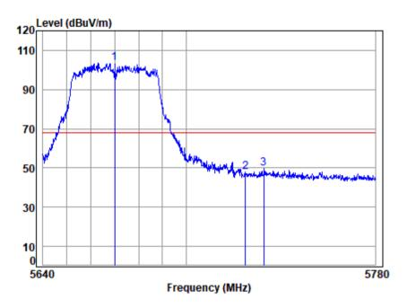
Site : chamber Condition: 3m VERTICAL : 00546AT/00547AT : 5670 Band edge Mode : 5G WIFI 11N40 Note
