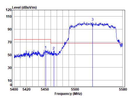
Site : chamber Condition: 3m VERTICAL Job No : 00546AT/00547AT Mode : 5530 Band edge 5G WTFT 11ΔX80 Note
