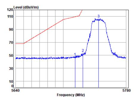
Site : chamber Condition: 3m VERTICAL : 00546AT/00547AT Mode : 5745 Band edge : 5G WIFI 11AC20 Note
