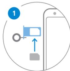
付属のSIM取り出しツールを使って、ご利用の携帯通信会社のSIMカードを挿入します。
