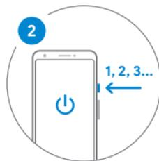
電源をオンにするには、電源ボタンを5秒間長押しします。画面上の指示に沿ってセットアップを開始します。
